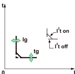
为了在间歇性电气故障时脱扣，脱扣单元累积接地故障脱扣范围内的间歇性电流，持续时间较短，不足以触发脱扣。此类累积可导致比设定值更短的脱扣时间。
