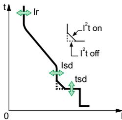
短延时过流吸合电流  $I_{sd}$  设定短路电流的水平，在此短路电流水平下，当达到短延时过流时间延迟时断路器脱扣。
