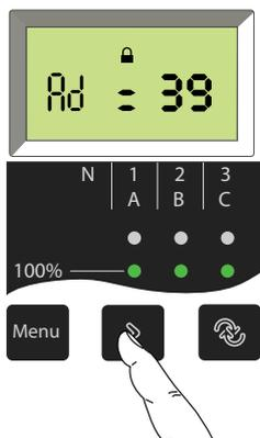
**NOTA:** La dirección máxima es 47. Si intenta configurar una dirección superior, la unidad de control MicroLogic ajustará la dirección en 47.
