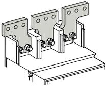
Cuando las conexiones mediante argollas o barras se realizan de acuerdo con las instrucciones de Schneider Electric (par de apriete, accesorios de montaje de acero de clase 8.8 y arandela de contacto), no es necesario realizar ningún mantenimiento en particular.
