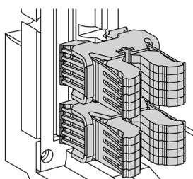
Las conexiones deslizantes entre el chasis y el aparato se componen de dos partes: los clusters y los contactos de desconexión. La grasa entre los clusters y los contactos de desconexión facilita la conexión e impide que se dañe la superficie revestida con plata al reducir la fricción durante la introducción.
