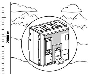
La altitud no afecta de manera significativa a las características de los aparatos hasta los 2000 m (6600 ft). Por encima de esta altitud, es necesario tener en cuenta la disminución de la rigidez dieléctrica y la capacidad de enfriamiento del aire. La siguiente tabla muestra las correcciones que se deben aplicar a altitudes superiores a 2000 m (6600 ft). Los poderes de corte no cambian.
