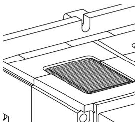
Durante un cortocircuito, la cámara de corte extingue el arco y absorbe el alto nivel de energía a lo largo de toda la trayectoria del cortocircuito. Las cámaras de corte también ayudan a extinguir arcos en condiciones de corriente nominal.
