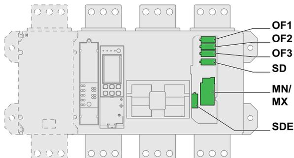
Los equipos auxiliares eléctricos OF1, OF2, OF3, SD y SDE pueden ser:
