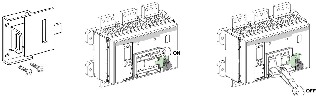
**NOTA:** El interruptor automático se dispara aunque esté bloqueado en la posición ON.
