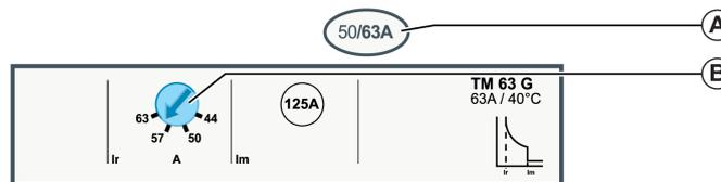
**A** Rango de ajuste para la unidad de control magnetotérmica TM-G
