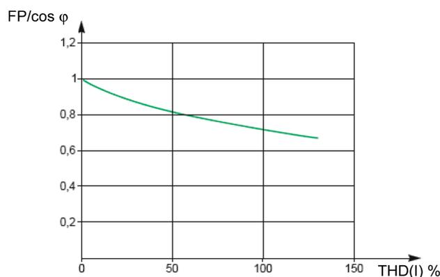
La comparación de los dos valores permite calcular el nivel de deformación armónica de la alimentación.
