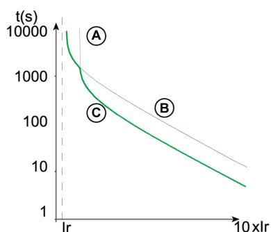
**A** Curva de temperatura límite para el cobre
