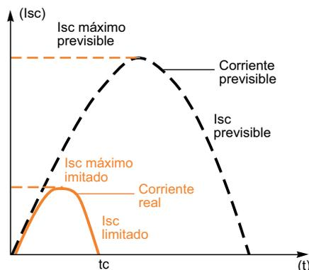
La excepcional capacidad de limitación de la gama ComPacT NSX se debe a la técnica de doble corte rotativo (repulsión natural muy rápida de los contactos y aparición de dos tensiones de arco en serie con un frente de onda muy elevado).
