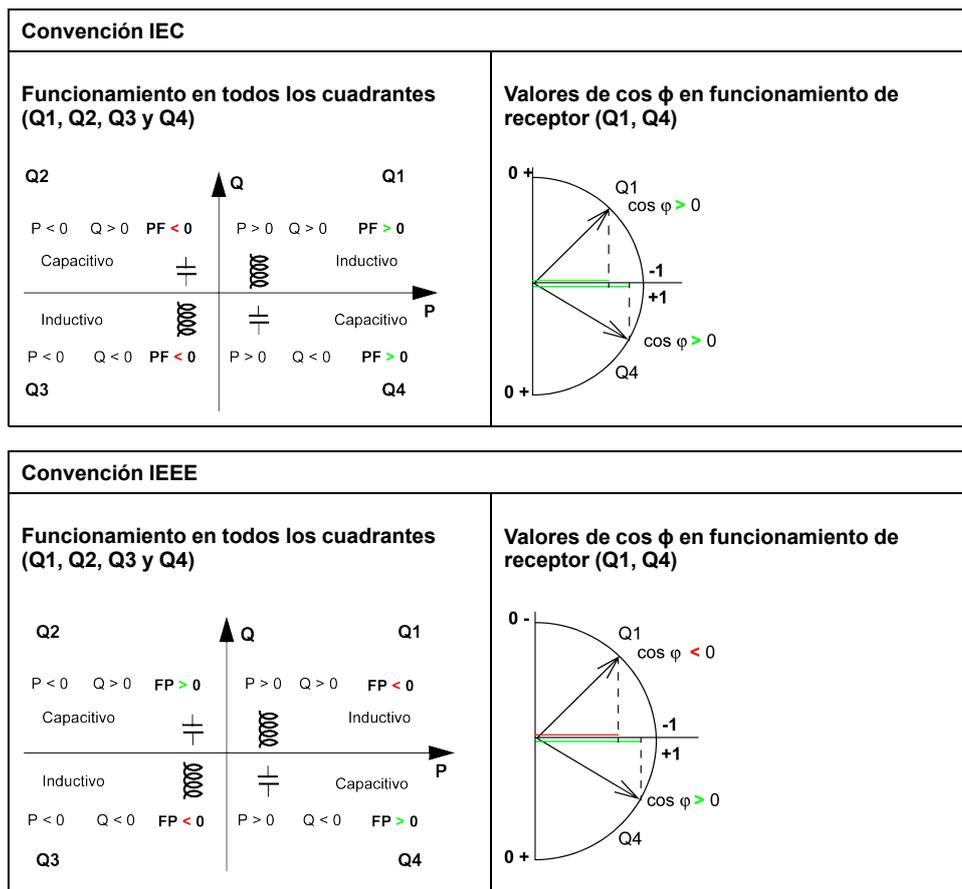
**NOTA:** Para un dispositivo, una parte de la instalación que es únicamente receptora (o generadora), la ventaja de la convención IEEE es que añade el tipo de componente reactivo a los indicadores FP y cos φ:
