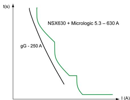
Active la función I<sup>2</sup>t (I<sup>2</sup>t encendido) en la protección de corto retardo para proporcionar la coordinación.
