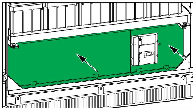
12. Fermez la ou les portes. Sur l'armoire batterie classique de 1 000 mm de large, installez deux vis pour fermer la porte de gauche.
