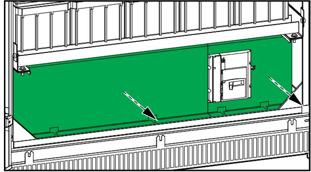
4. Retirez le cache borne du côté gauche du disjoncteur batterie.
