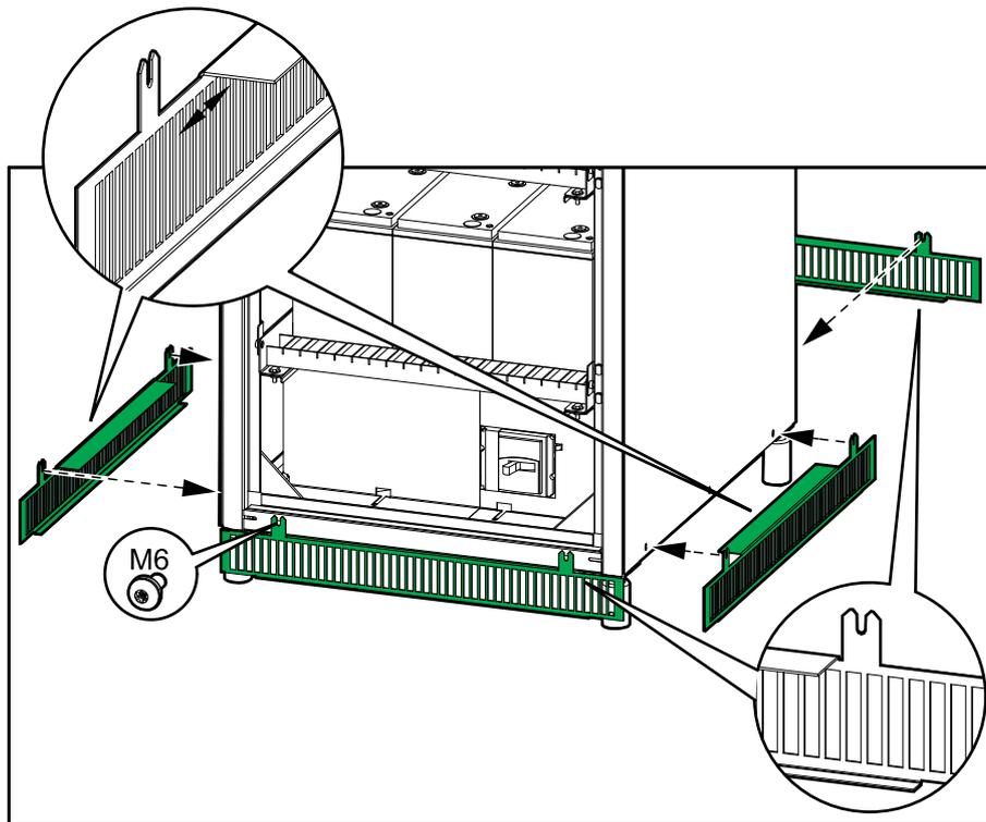
**NOTE:** Ne retirez les bandeaux que lorsque vous suivez la procédure de démantèlement ou de déplacement de l'armoire batterie classique. Pour plus de détails, reportez-vous à la section Démantèlement ou déplacement de l'armoire batterie classique vers un nouvel emplacement, page 36.
