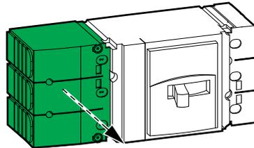
5. Déconnectez et retirez les câbles CC, les câbles N et le câble PE du disjoncteur batterie.
