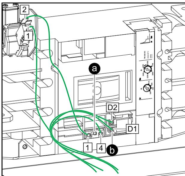
8. Acheminez les câbles de signal de l'arrière du disjoncteur batterie, par le bas de l'armoire batterie classique, puis raccordez-les :
