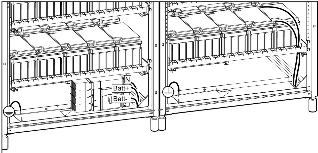
7. Déconnectez et retirez les interconnexions entre les batteries de chaque étagère. Déconnectez et retirez les câbles de batterie du côté droit du disjoncteur batterie. Reportez-vous au schéma de raccordement à l'intérieur de la porte avant de l'armoire batterie classique.
