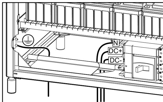
3. Acheminez les câbles CC de l'ASI par le bas de l'armoire batterie classique et raccordez les câbles batterie (N, CC+, CC-). Utilisez des rondelles de blocage (non fournies) lorsque vous raccordez les câbles CC.
