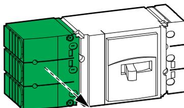
7. Retirez le panneau du disjoncteur batterie et raccordez les câbles de signal au disjoncteur batterie.
