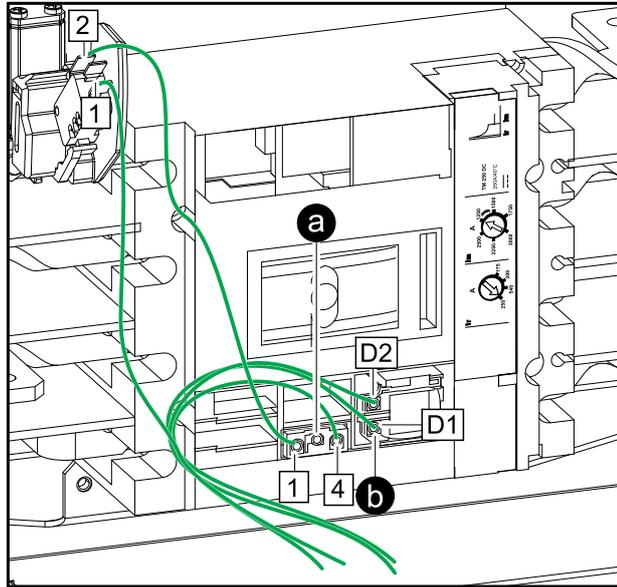
5. Conecte los cables de señalización siguiendo uno de los diagramas a continuación para el **Easy UPS 3M**:
