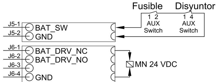
**Cables de señalización en instalaciones con dos disyuntores de batería**
