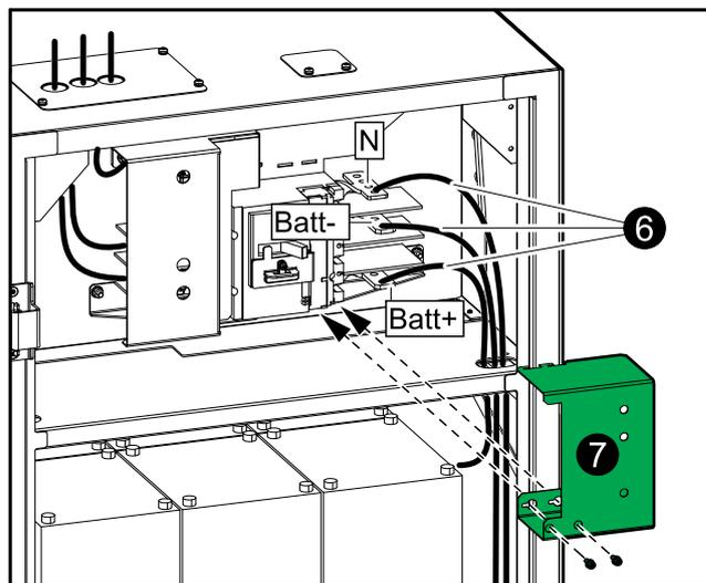
7. Coloque la cubierta de protección sobre los terminales de la parte derecha del disyuntor de batería.
