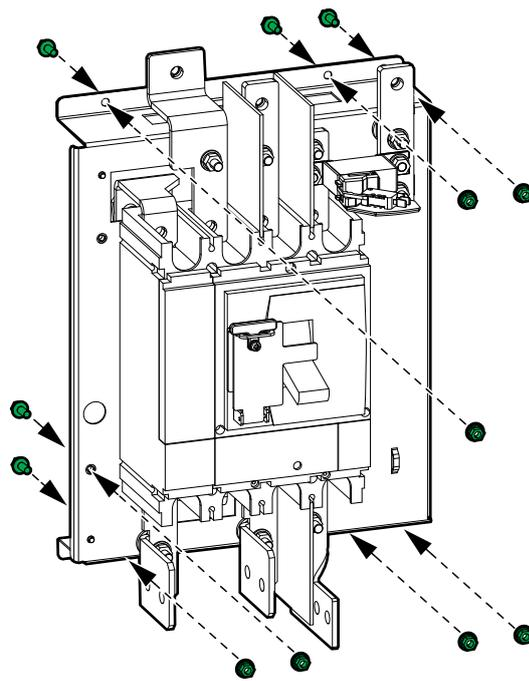
1. Mida y marque los orificios para montar el kit de disyuntor de batería en la caja metálica.
