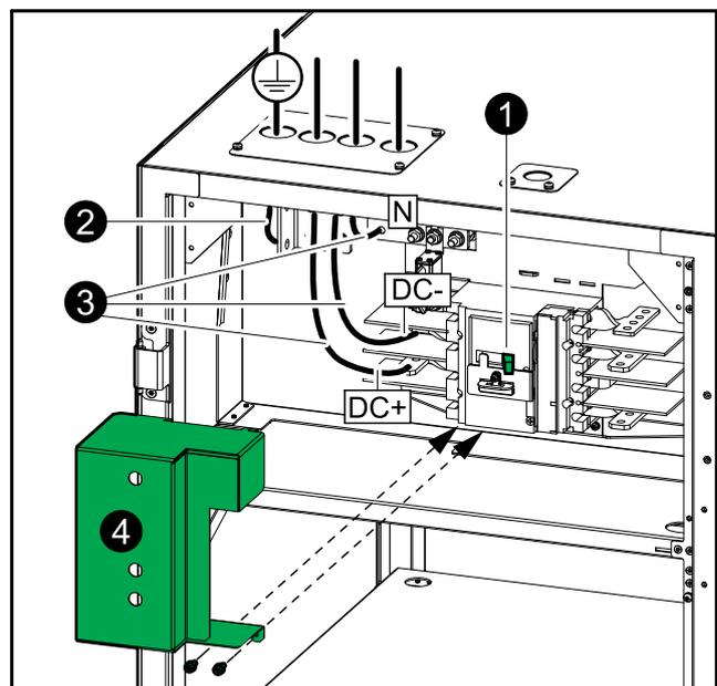
2. Conecte el cable de punto de protección a tierra (PE).
