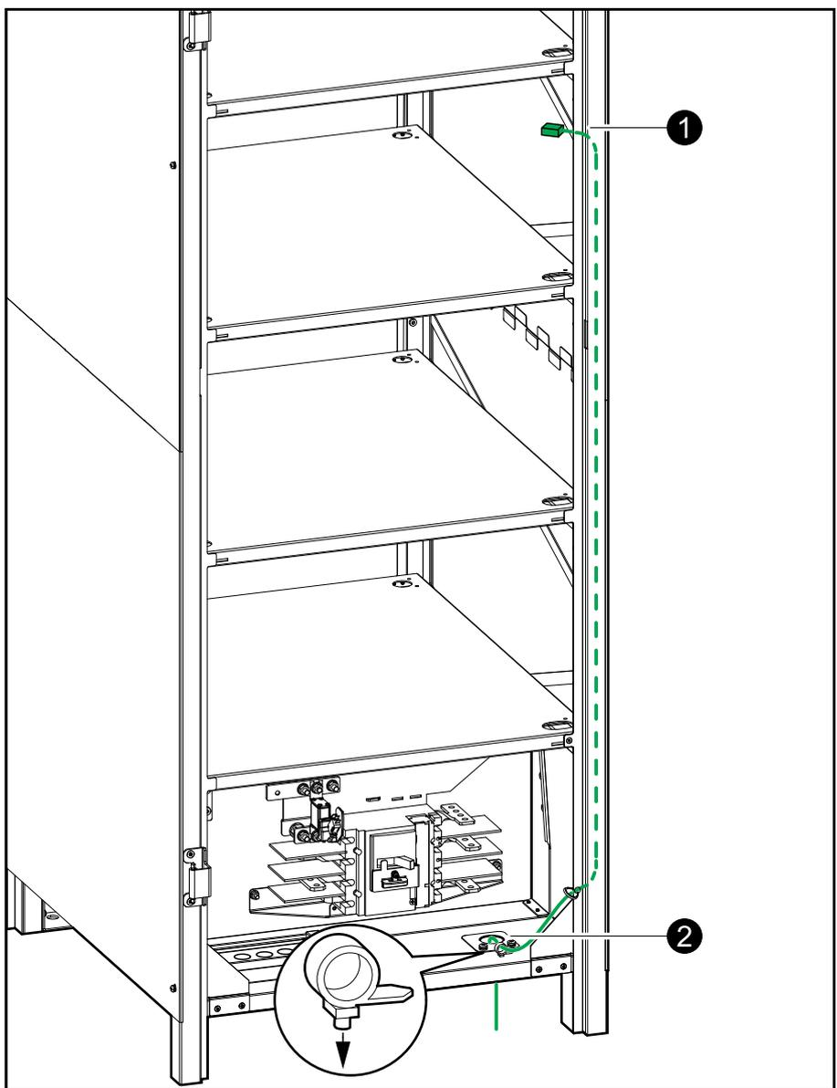
2. Pase los cables del sensor de temperatura de las baterías por la parte superior o inferior del armario de baterías vacío hasta los terminales de contacto seco BAT\_T para el Easy UPS 3M y J12 para el UPS 3L.
