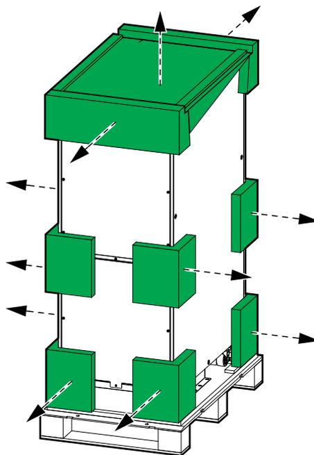
3. Desserrez les vis et retirez les supports d'expédition. Conservez les boulons pour la rampe et éliminez les supports d'expédition.
