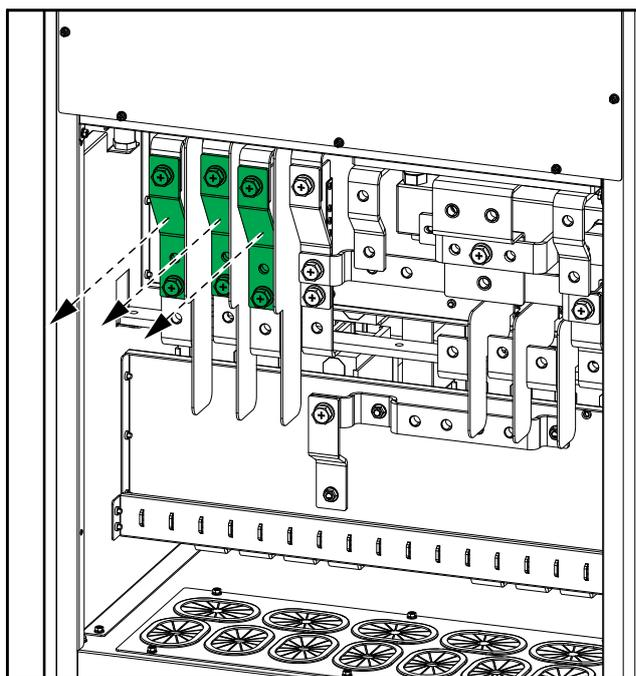
4. Pour les régimes de neutre TN-C uniquement, faites pivoter le cavalier de jeu de barres pour créer une connexion entre le jeu de barres PE et le jeu de barres neutre.
