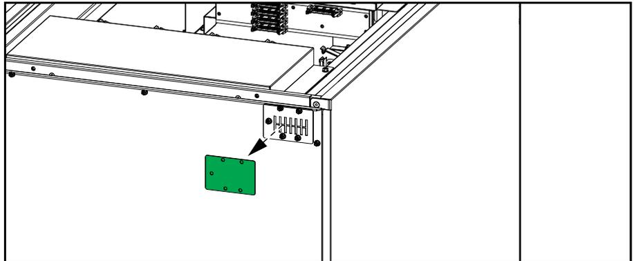
3. Acheminez les câbles de signal à travers la plaque à fentes arrière via le canal de câble et vers l'interface de communication à l'avant de l'ASI.
