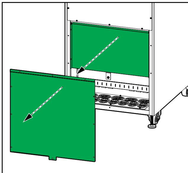
3. Dans le cas d'une alimentation double, retirez les trois jeux de barres qui permettent d'alimenter l'ASI avec une seule alimentation.
