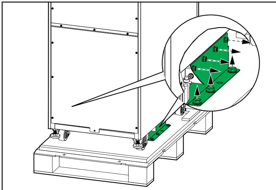
4. Placez la rampe à l'arrière et fixez-la à la palette avec les boulons du support d'expédition.
