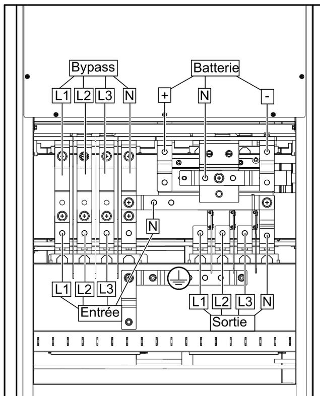
7. Raccordez les câbles d'entrée, de sortie et de bypass (le cas échéant).
