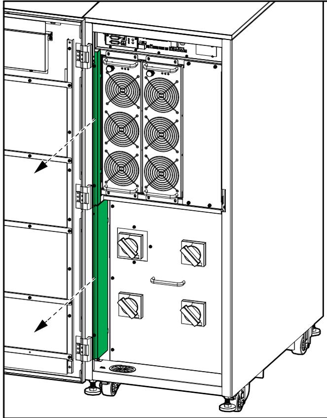
2. Acheminez les câbles de signal par le bas et vers l'interface de communication. Fixez les câbles aux séparateurs de câbles.
