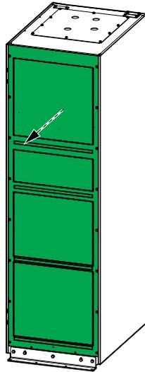
2. 可选：为了方便移动深度机柜，您可拆下深度适配器的前门。
