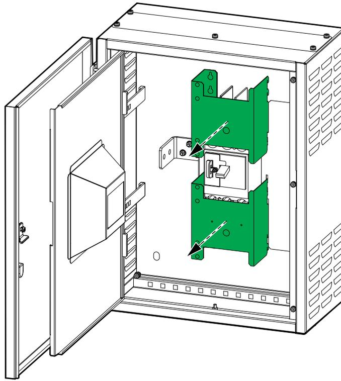
2. Far passare i cavi di segnale nella parte superiore o inferiore della scatola interruttori delle batterie.
