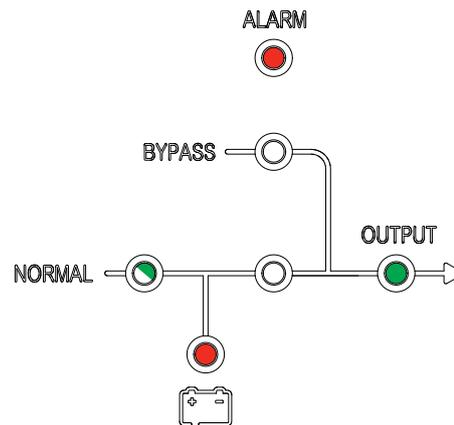
4. Quando il LED del raddrizzatore diventa di colore verde fisso, l'UPS esegue il trasferimento alla modalità di bypass statico.
