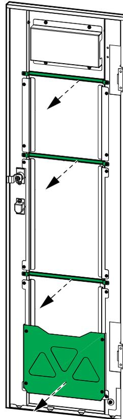
3. Sostituire il filtro antipolvere.
