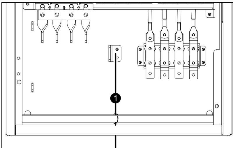
2. Collegare i cavi di alimentazione all'interruttore di bypass di manutenzione.
