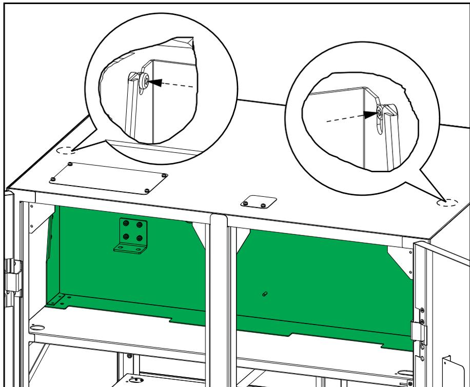
6. Rimuovere le piastre isolanti per (a) i cavi di alimentazione e (b) i cavi di segnale.
