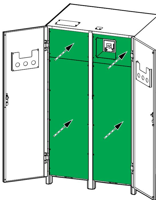
2. Fissare la staffa di ancoraggio anteriore all'armadio delle batterie vuoto con le viti M6.
