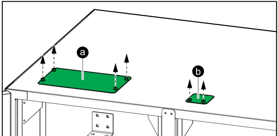
7. Trapanare o praticare fori per i cavi di alimentazione e di segnale nelle piastre isolanti.
