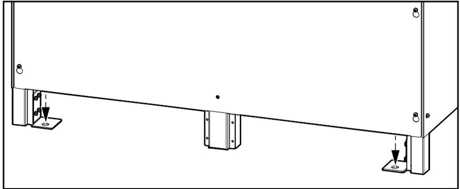
4. **Solo per l'installazione con due armadi delle batterie vuoti:** Montare le staffe d'alloggiamento superiori tra gli armadi delle batterie vuoti.
