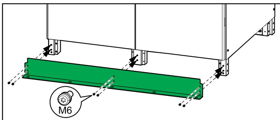
3. Installare la staffa di ancoraggio anteriore sul pavimento.
