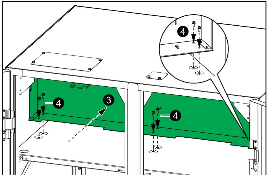
4. Fissare la parte inferiore della piastra dell'interruttore delle batterie con sei viti.
