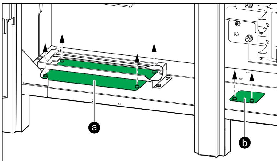
2. Trapanare o praticare fori per i cavi di alimentazione e di segnale nelle piastre isolanti.
