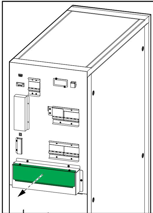
3. Nei sistemi a doppia rete di alimentazione, rimuovere i tre ponticelli per la rete di alimentazione singola.
