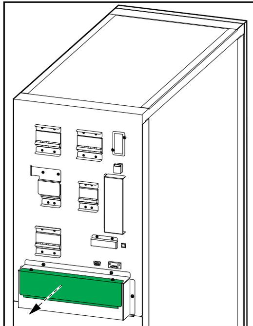
3. Nei sistemi a doppia rete di alimentazione, rimuovere i tre ponticelli per la rete di alimentazione singola.
