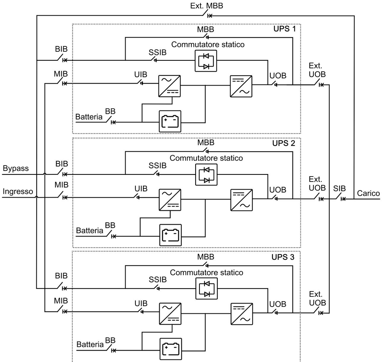
In un sistema UPS in parallelo, l'impedenza dei percorsi di bypass deve essere controllata. Quando si opera in modalità bypass, la condivisione del carico in parallelo è determinata dall'impedenza totale del percorso di bypass, che include i cavi, il quadro elettrico, il commutatore statico e la configurazione dei cavi.
