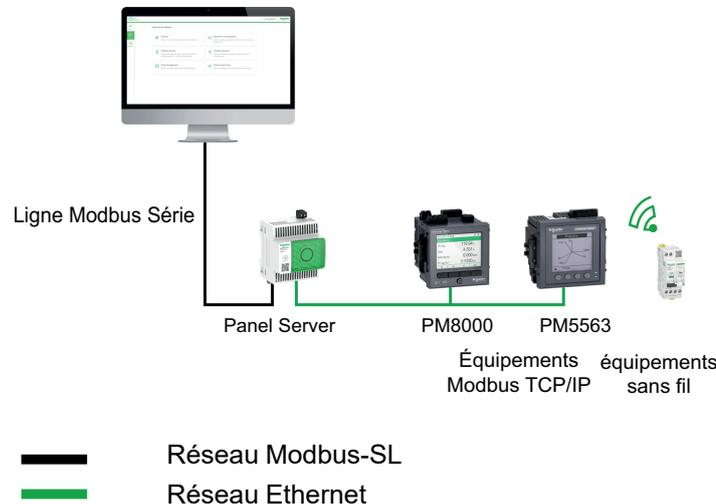
Le mode inverse Modbus-SL est défini et surveillé dans les pages Web Panel Server sous **Paramètres > Produits Modbus**. Dans **Configuration Modbus** modifiez le **Mode Modbus de Client** en **Serveur**.
