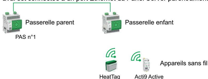
**NOTE:** Panel Server Universal et Advanced permettent d'afficher les données des appareils sans fil connectés à une passerelle enfant. La passerelle Panel Server parent surveille l'état de communication Modbus TCP/IP de la passerelle enfant et de ses appareils sans fil en aval et signale une alarme lorsque la passerelle enfant se déconnecte.
