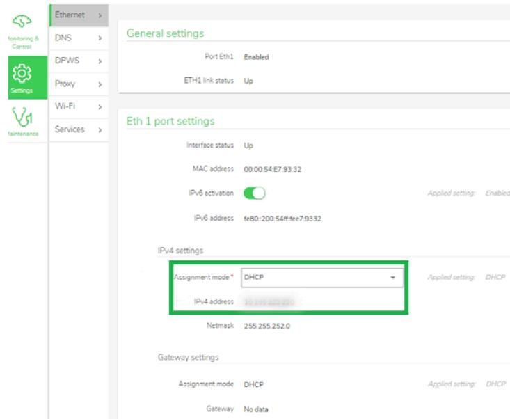
13. Retournez aux pages Web Panel Server sous **Paramètres > Configuration du réseau** pour désactiver le Wi-Fi.
