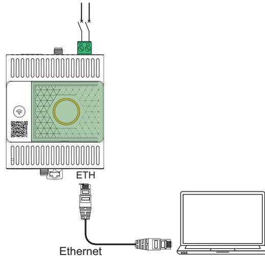
Gehen Sie vor wie folgt, um einen PC mit einem Panel Server über Ethernet zu verbinden:
