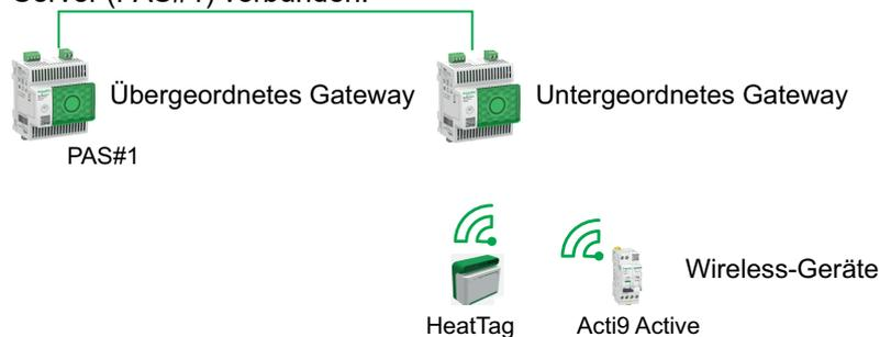
**HINWEIS:** Der Panel Server Universal und Advanced ermöglicht die Anzeige von Daten von Wireless-Geräten, die mit einem untergeordneten Gateway verbunden sind. Das übergeordnete Panel Server-Gateway überwacht den Modbus TCP/IP-Kommunikationsstatus des untergeordneten Gateways und seiner nachgeschalteten Wireless-Geräte und meldet einen Alarm, wenn das untergeordnete Gateway die Verbindung trennt.
