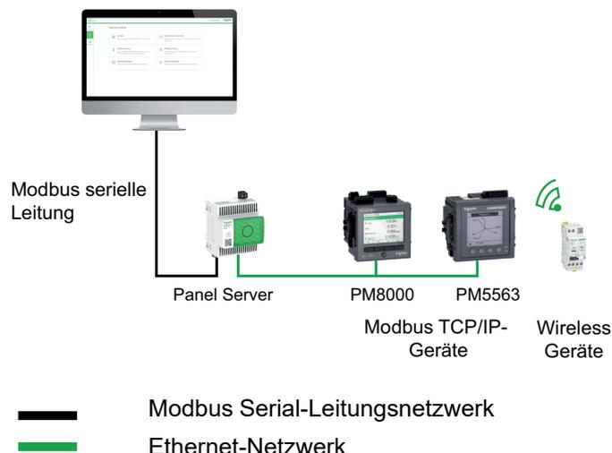
Der Modbus SL-Rückwärtsmodus wird auf den Webseiten des Panel Server unter **Einstellungen > Modbus-Geräte** eingestellt und überwacht. Ändern Sie in der **Modbus-Konfiguration** den **Modbus-Betrieb** von **Client** zu **Server**.
