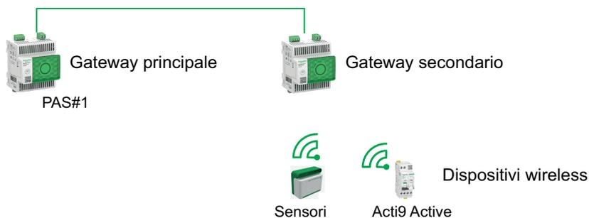
**NOTA:** Panel Server Universal e Advanced consentono di visualizzare i dati dai dispositivi wireless collegati a un gateway secondario. Il gateway Panel Server principale monitora lo stato della comunicazione Modbus TCP/IP del gateway secondario e dei relativi dispositivi wireless a valle e segnala un allarme quando il gateway secondario si scollega.
