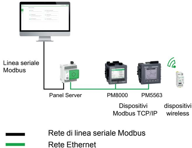
La modalità inversa Modbus-SL viene impostata e monitorata nelle pagine Web di Panel Server in **Impostazioni > Dispositivi Modbus**. In **Configurazione Modbus** modificare la **Modalità Modbus** da **Client** a **Server**.
