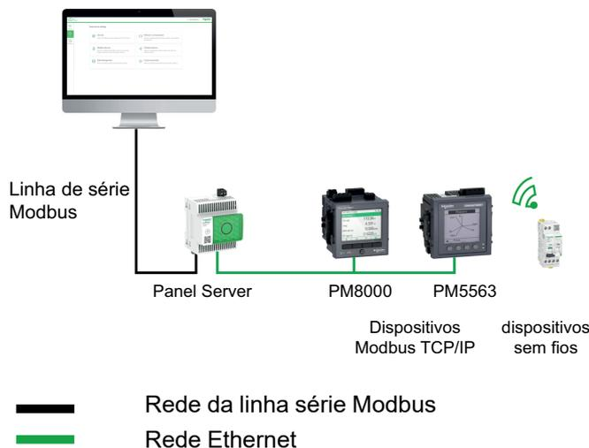
O modo inverso Modbus-SL é definido e monitorizado nas páginas Web do Panel Server em **Definições > Dispositivos Modbus**. Em **Configuração Modbus**, altere o **Modo Modbus** de **Cliente** para **Servidor**.
