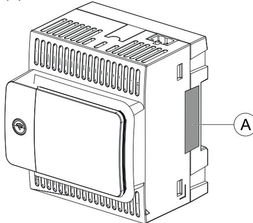
Antes de instalar, utilizar, efetuar a reparação ou manutenção do EcoStruxure Panel Server, verifique a integridade da etiqueta com indicação de adulteração.
