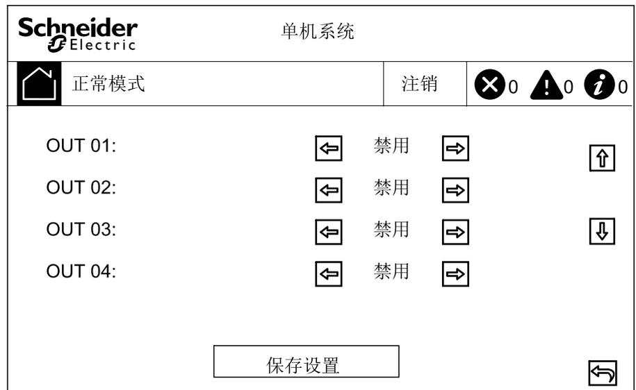
4. 点击向下箭头，分别设置每个可配置输入接点的功能。请注意，有两个输入接点屏幕。可用选项包括：
