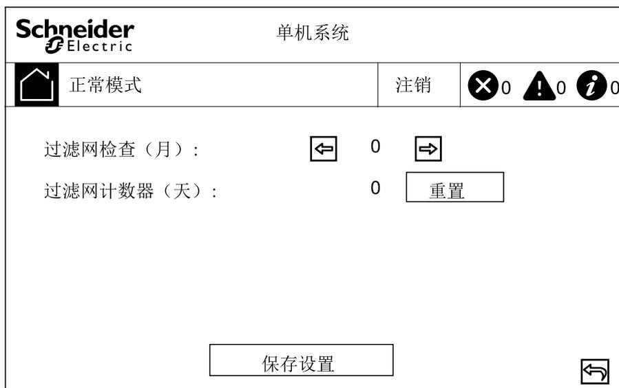
2. 设置检查过滤网的时间间隔（月）。系统会在需要检查过滤网时生成**检查过滤网**的消息。
