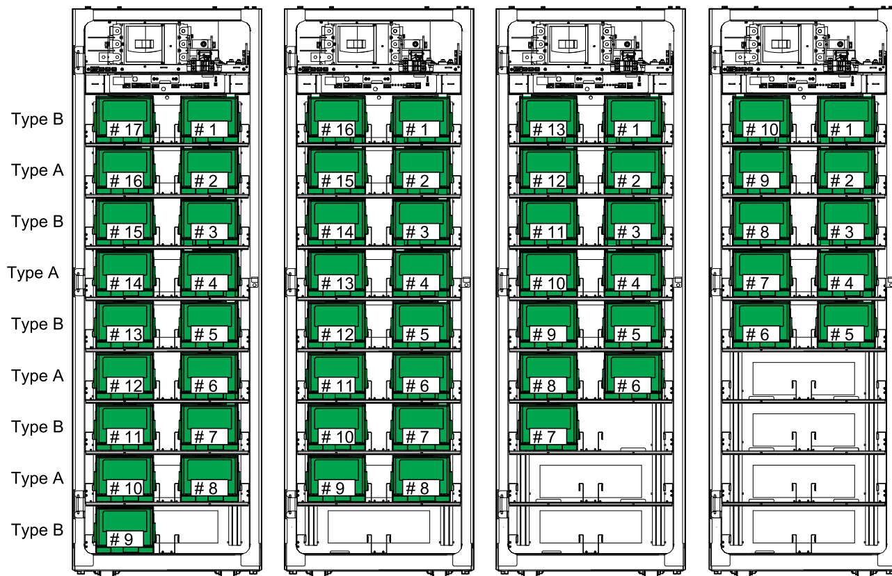
电池柜电池配置 (带 17、16、13 和 10 个电池模块)
