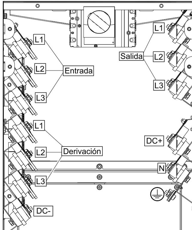
11. Desconecte y retire todos los cables de alimentación del SAI. Para obtener más información, consulte [Conexión de los cables de alimentación](#), página 92 o [Conexión de los cables de alimentación con placas de 2 orificios NEMA](#), página 97.
