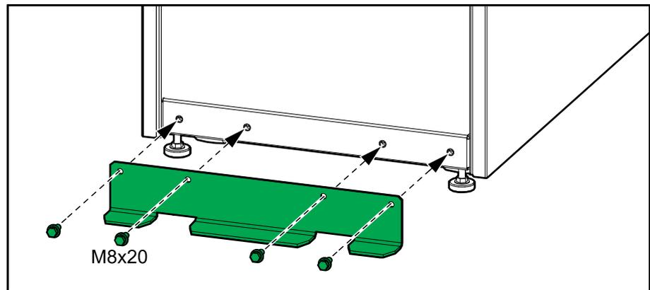
3. Encaje el SAI para que el soporte de anclaje posterior se conecte con el anclaje posterior. El soporte de anclaje delantero se coloca en los últimos pasos de la instalación.
