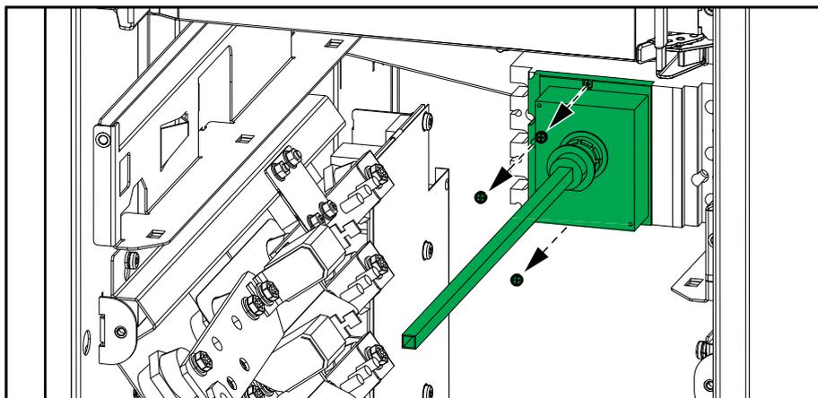
6. Instale un interruptor AUX adicional (se suministra) en la posición OF2 en el dispositivo de desconexión de mantenimiento interno (IMB) en ambos SAI.
