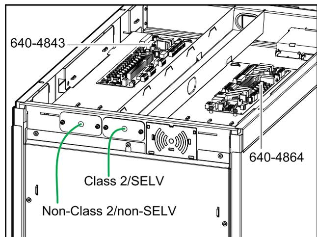
14. Pase los cables de señal de no-Clase 2/no-SELV por la placa guía/de escobillas trasera izquierda y por el lado izquierdo del SAI.
