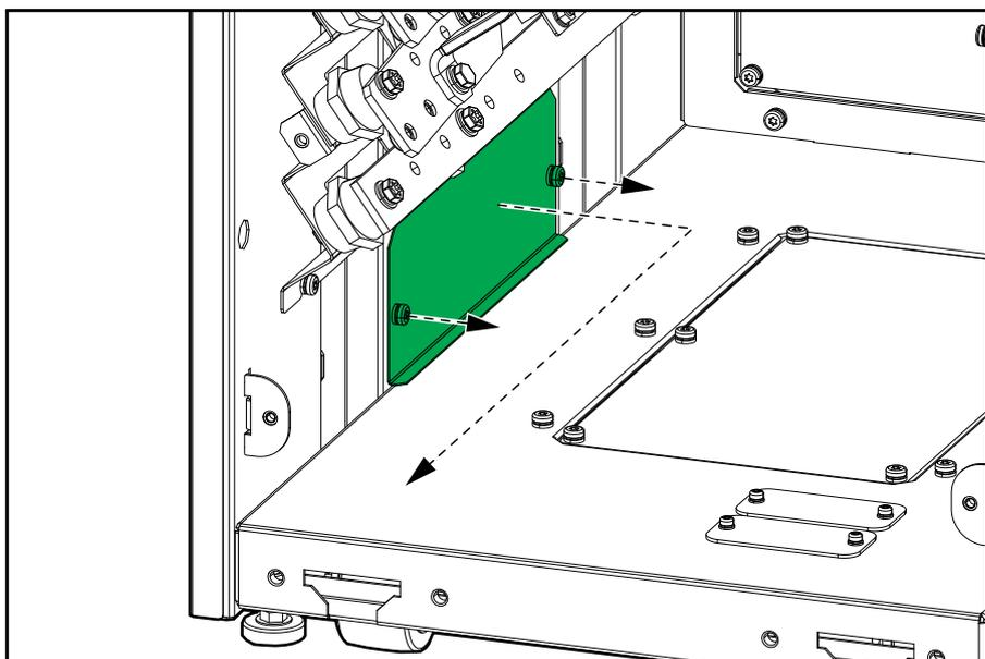
7. **Para instalación con armario auxiliar adyacente en el lado derecho del SAI:** Retire la placa del panel lateral derecho. El panel lateral se reinstala en algunos armarios auxiliares adyacentes. Siga el manual del producto auxiliar adyacente.
