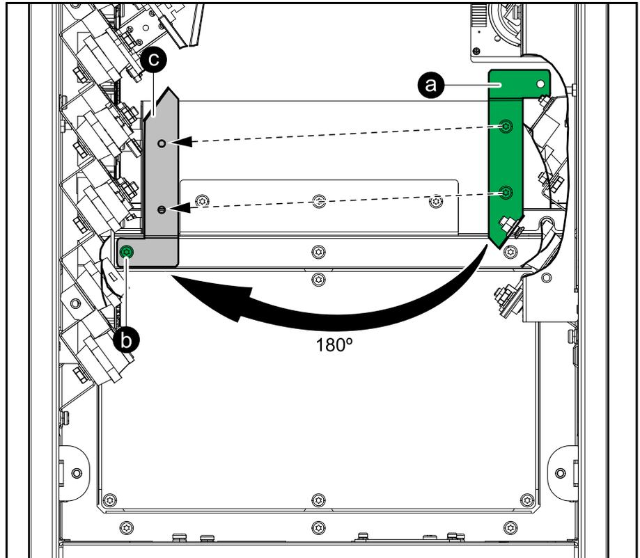
2. **Solo para sistemas con suministro de red con dos entradas:** Retire los tres puentes de la barra colectora del suministro de red simple principal.
