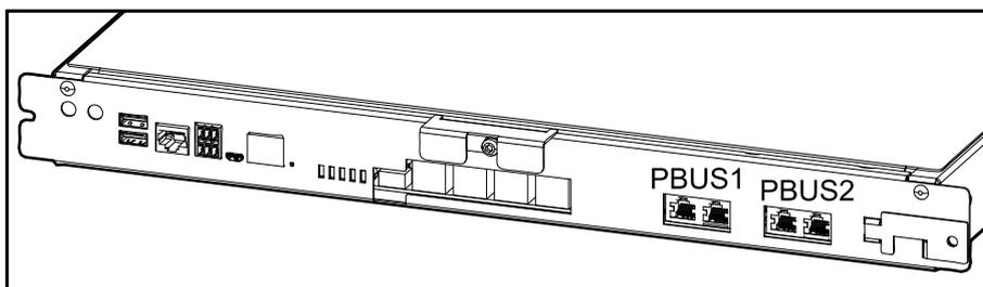
2. Instale los terminadores (T) en los conectores no utilizados.
