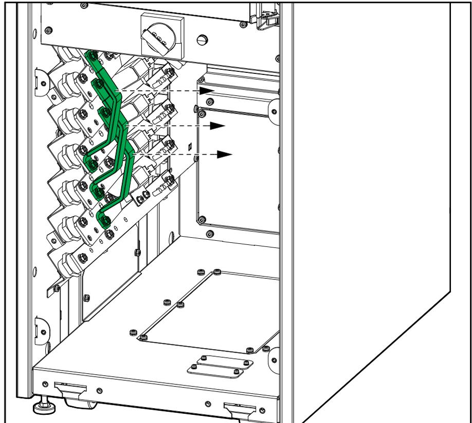
3. Conecte los cables de alimentación como se muestra en el orden que se indica:
