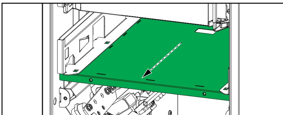
5. Retire la tapa frontal del dispositivo de desconexión de mantenimiento interno (IMB) en ambos SAI.
