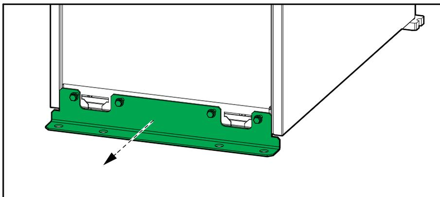
18. Si el SAI está instalado en el kit de montaje GVSOPT027, desmóntelo. Para obtener más información, consulte el manual de instalación suministrado con el kit.
