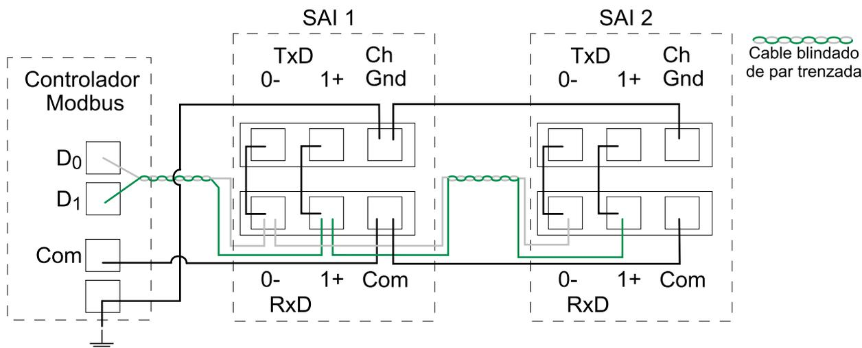
**Por ejemplo, Conexión de cuatro hilos con dos SAI**
