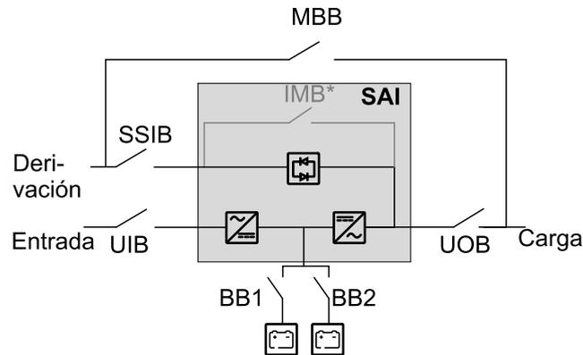
**NOTA:** El disyuntor interno de derivación de mantenimiento IMB\* no se puede utilizar en un sistema con un disyuntor externo de derivación de mantenimiento (MBB). El disyuntor interno de derivación de mantenimiento (IMB)\* debe bloquearse con candado en la posición abierta.
