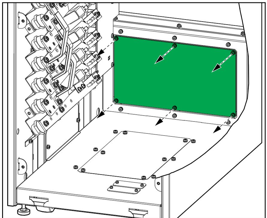
10. Perfore los orificios para cables de alimentación o conductos en la placa guía. Instale los conductos (no suministrados), si procede.
