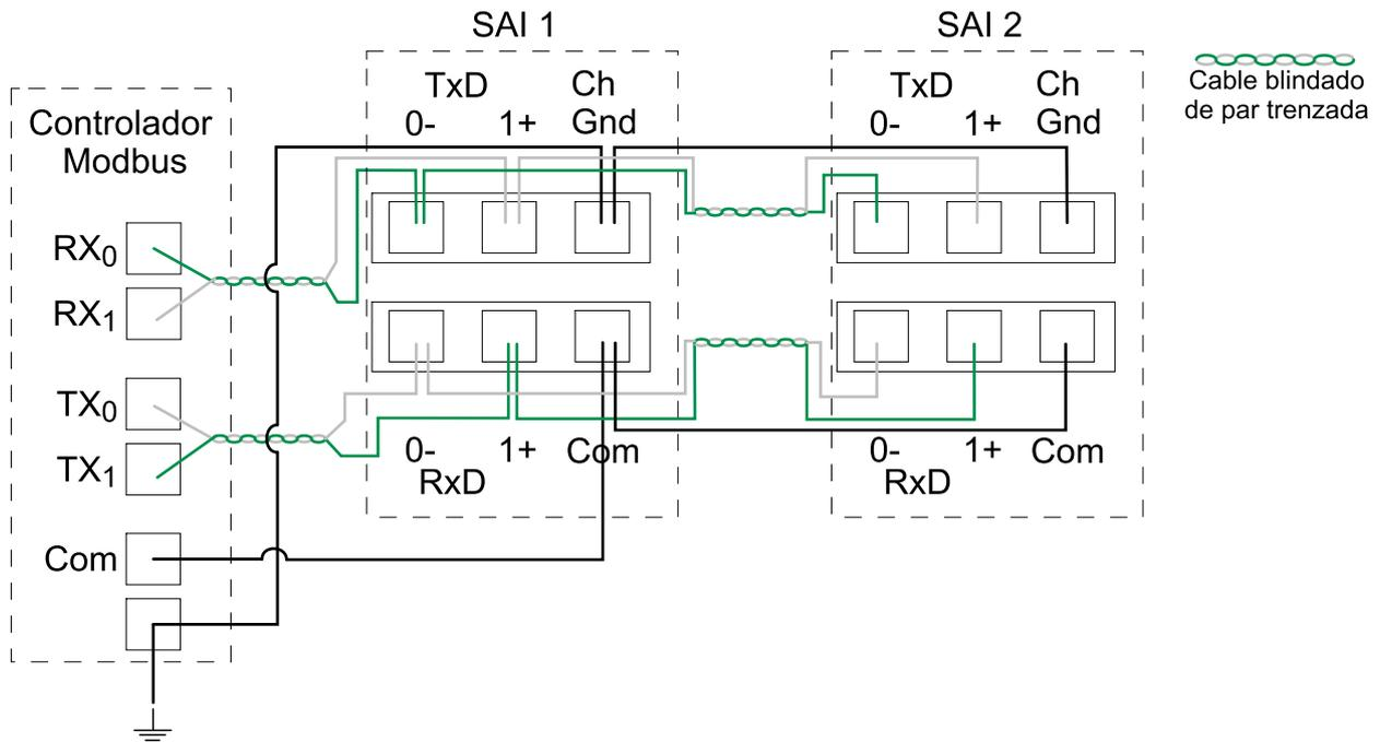
2. Instale resistencias de terminación de 150 ohmios en cada extremidad de cada bus si los buses son muy largos y funcionan a velocidades de datos altas. Los buses inferiores a 610 metros (2000 pies) a 9600 baudios o inferiores a 305 metros (1000 pies) a 19 200 baudios en principio no necesitan resistencias de terminación.
