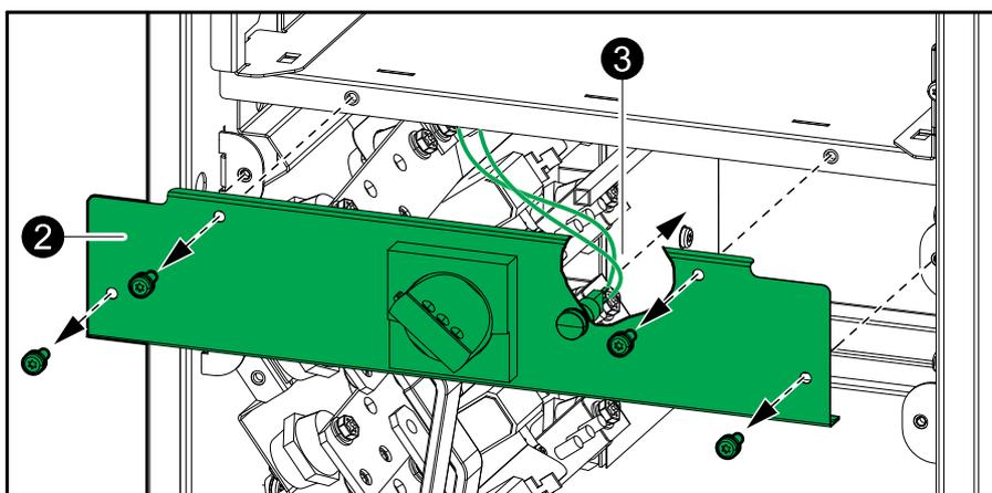
3. Desconecte los cables de señal del indicador luminoso del dispositivo de desconexión de mantenimiento interno (IMB) en ambos SAI.
