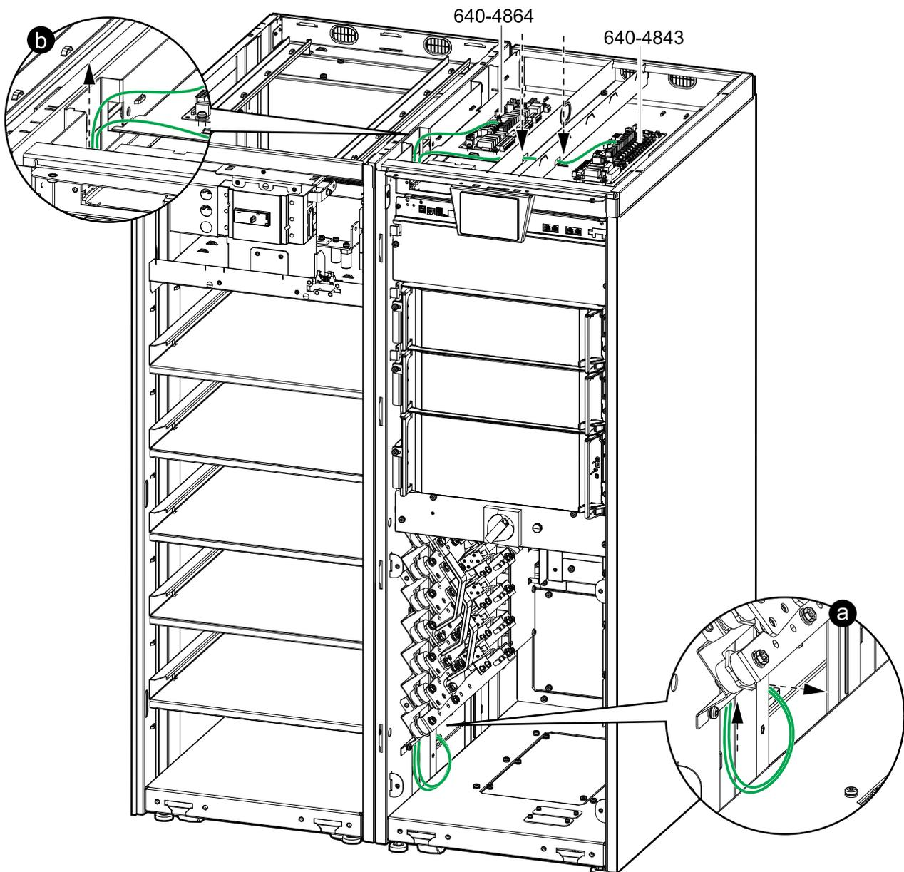
3. Conecte los cables de señal del armario de baterías modulares 1 al SAI:
