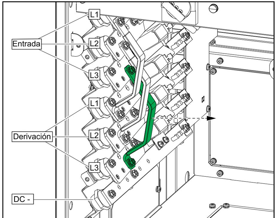
3. Instale las placas de 2 orificios NEMA y conecte los cables de alimentación como se muestra en el orden que se indica:
