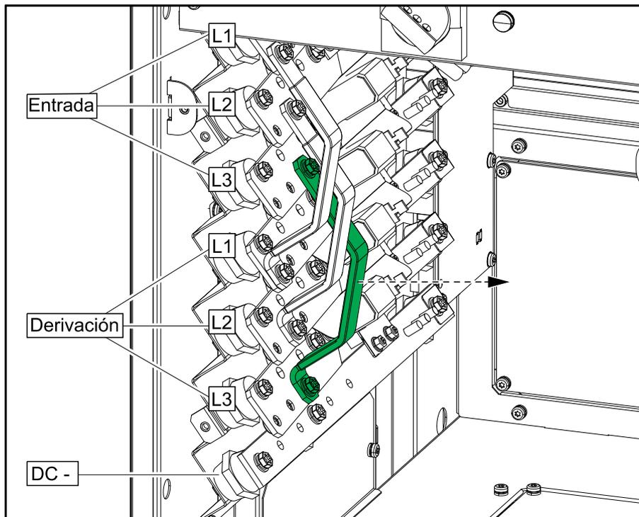
3. Instale las placas de 2 orificios NEMA y conecte los cables de alimentación como se muestra en el orden que se indica:
