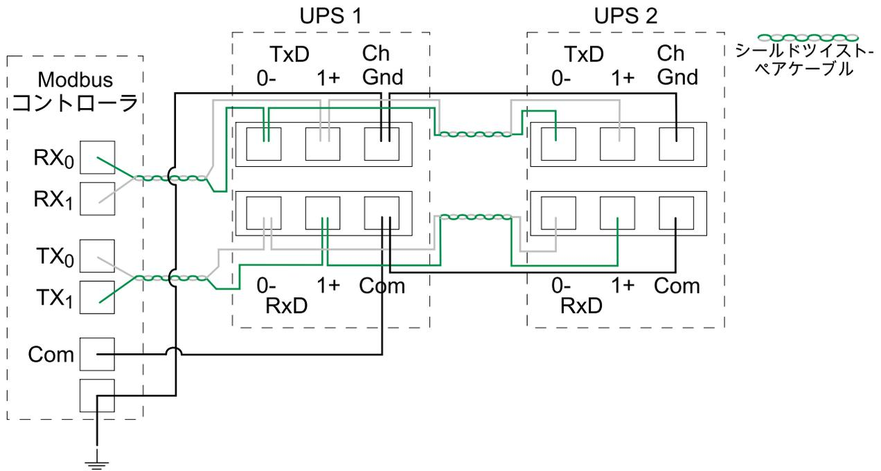
2. バスが非常に長く、高データレートで動作する場合は、各バスのそれぞれの両端に150オームの終端抵抗器を取り付けます。9600ボーレートで610メートル（2000フィート）を下回る、または19,200ボーレートで305メートル（1000フィート）を下回るバスは、終端抵抗器は必要ありません。
