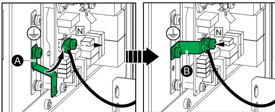
2. **2系統主電源システムの場合のみ：** 出力端子 / バイパス端子の背面にある以下の1系統主電源のジャンパーケーブルを取り外します。
