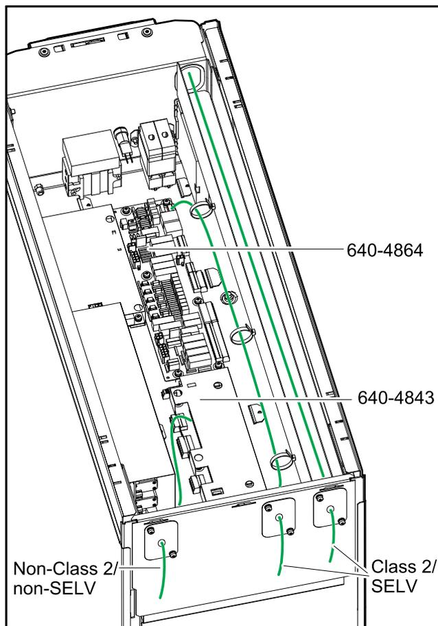
7. Class 2/SELVの信号線を中央の背面ブラシプレート / 配線口カバーから通して、UPSの内部に配線します。
