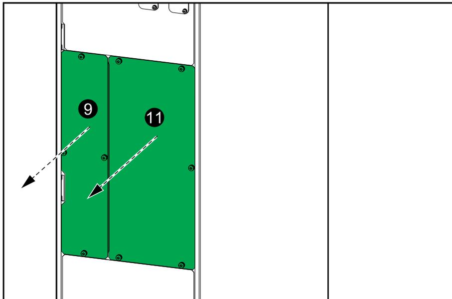
10. 配線口カバーに電源ケーブル / 電線管用の穴を開けます。必要に応じて、電線管 ( 付属していません ) を取り付けます。
