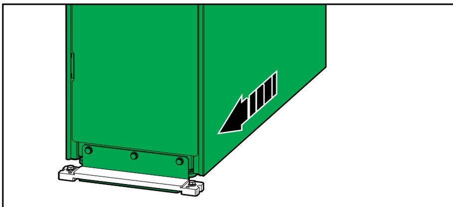
4. レンチを使用して、UPSの前面と背面の水平調節の脚部を床面に着くまで下げます。水平器を使用してUPSが水平であることを確認します。
