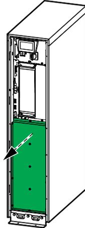
8. すべてのバッテリーモジュールの前面からバッテリー端子を取り外します。
