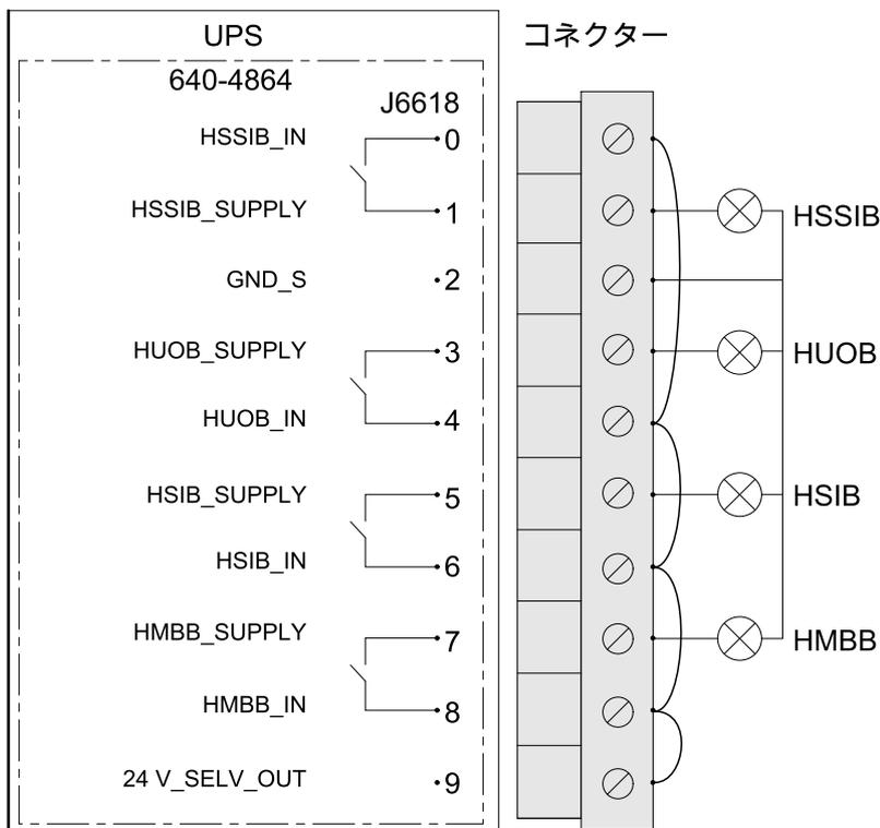
2. スwitchギアの補助スイッチからUPS上部にあるボード640-4843に信号線を接続します。
