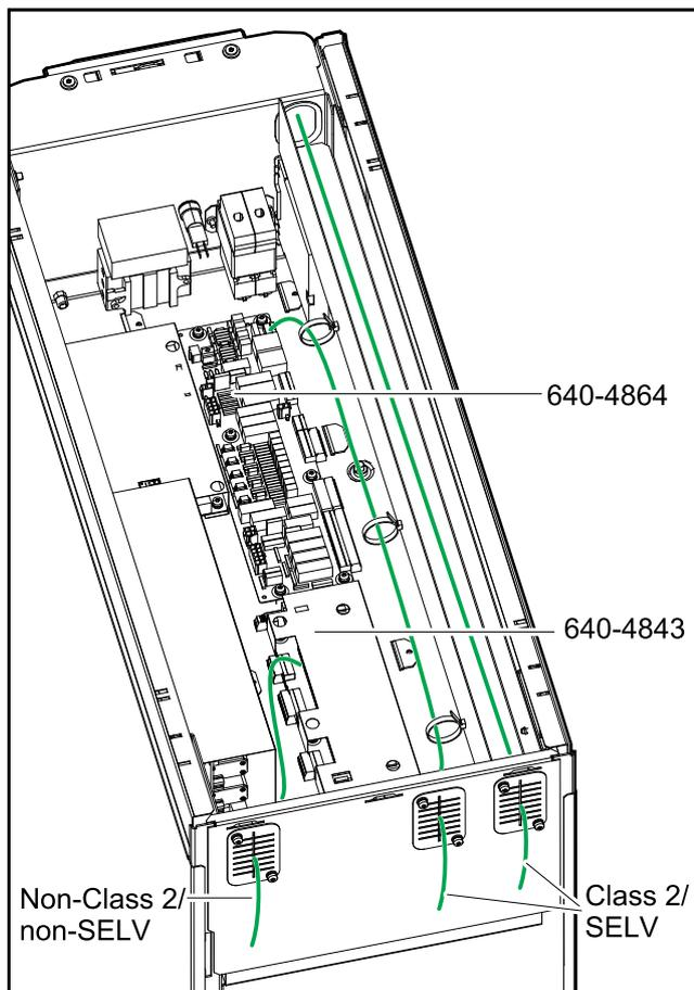
**電線管を使用したUPSの上面図**
