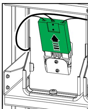
4. 背面の配線口カバーと背面のブラシプレートをUPSから取り外します。これは信号線を配線するためです。
