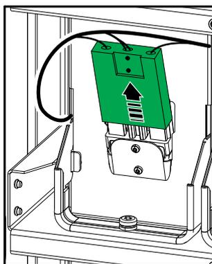
9. 上部2列のバッテリーモジュールを取り外します。重量の安定性を高めるために下部2列のバッテリーモジュールを残します。
