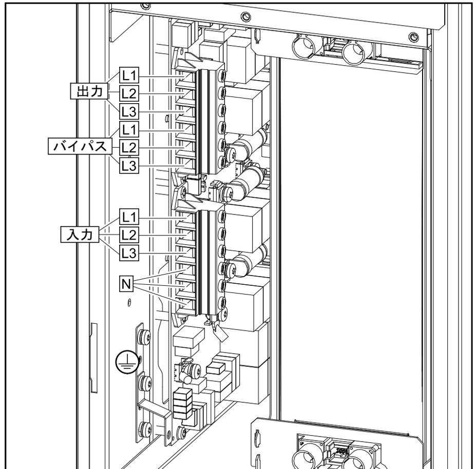
12. UPSからすべての電源ケーブルを取り外します。UPSに背面プレートを再度取り付けます。詳細については、電源ケーブルの接続, 43 ページを参照してください。
