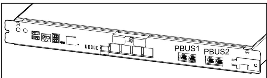
2. Montare i tappi di terminazione (T) nei connettori non utilizzati.
