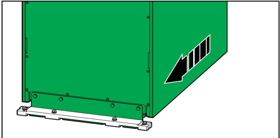
4. Abbassare i piedini di livellamento anteriori e posteriori sull'UPS con una chiave inglese finché non si appoggiano al pavimento. Utilizzare una livella a bolla per verificare la messa in piano dell'UPS.
