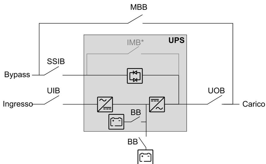
**NOTA:** Il sezionatore di manutenzione interno (IMB)\* non può essere utilizzato in un sistema con interruttore di manutenzione bypass (MBB) e il sezionatore di manutenzione interno (IMB)\* deve essere bloccato in posizione aperta.
