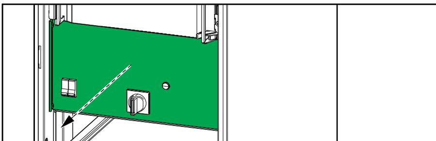
3. Collegare il cavo PE/conduttore messa a terra apparecchiature (0W49449) alla sbarra G/PE dell'UPS.
