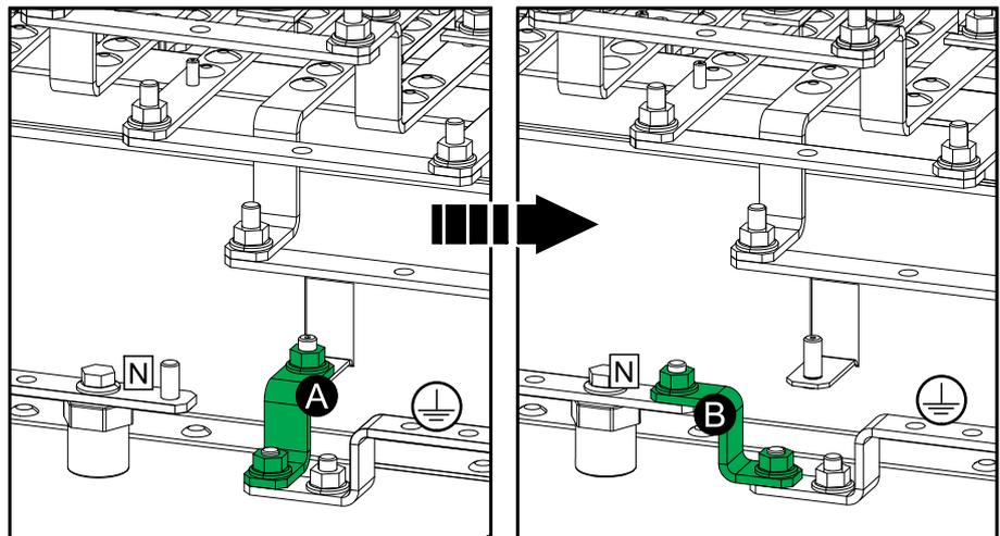
2. Rimuovere le tre sbarre ponticello dell'alimentazione singola.
