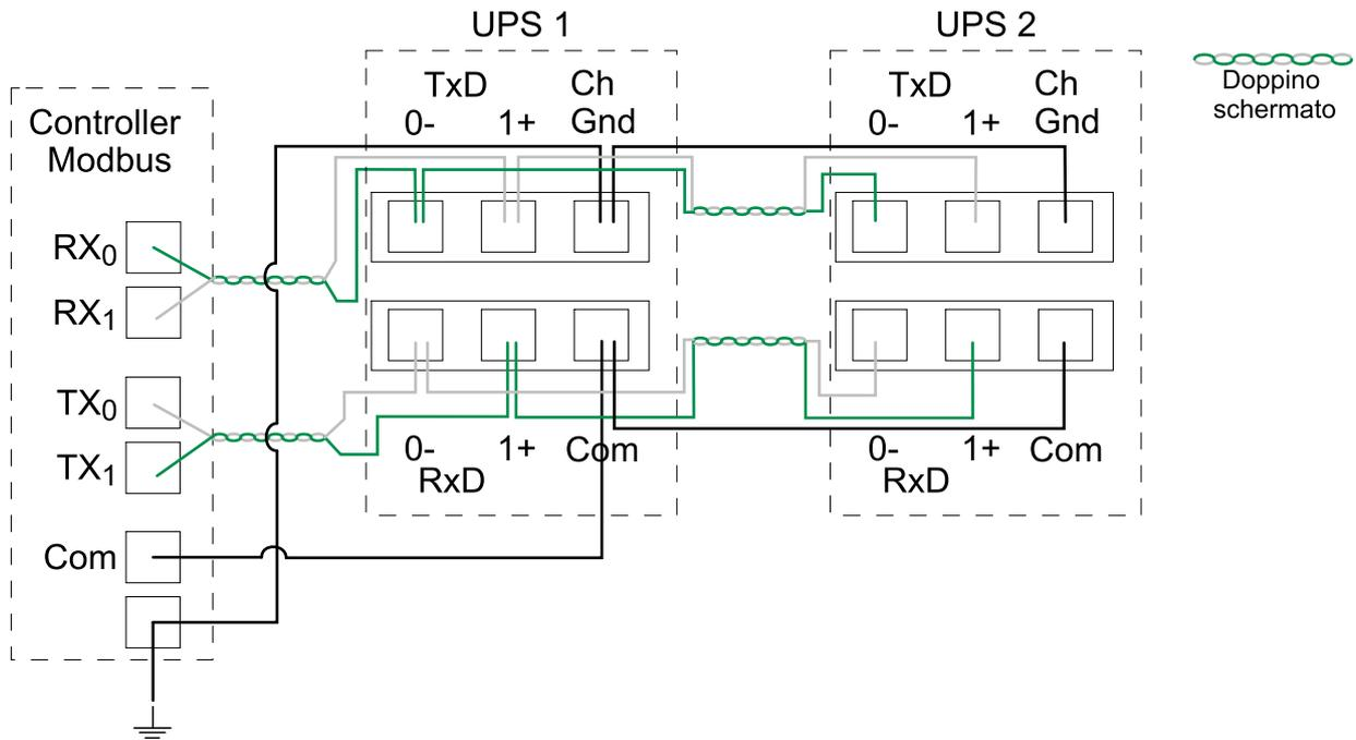
2. Se i bus sono molto lunghi e funzionano a velocità elevate, installare resistori di terminazione da 150 Ohm a ciascuna estremità di ogni bus. I bus al di sotto di 610 metri (2000 piedi) a 9600 baud o al di sotto di 305 metri (1000 piedi) a 19200 baud non dovrebbero richiedere resistenze di terminazione.
