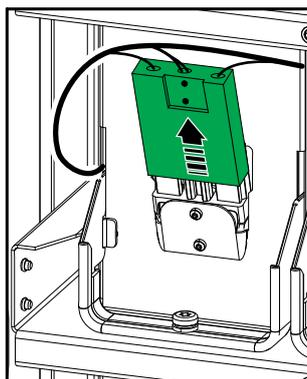
10. Rimuovere i moduli batteria dalle due file superiori. Lasciare i moduli batteria nelle due file inferiori per aumentare la stabilità del peso.
