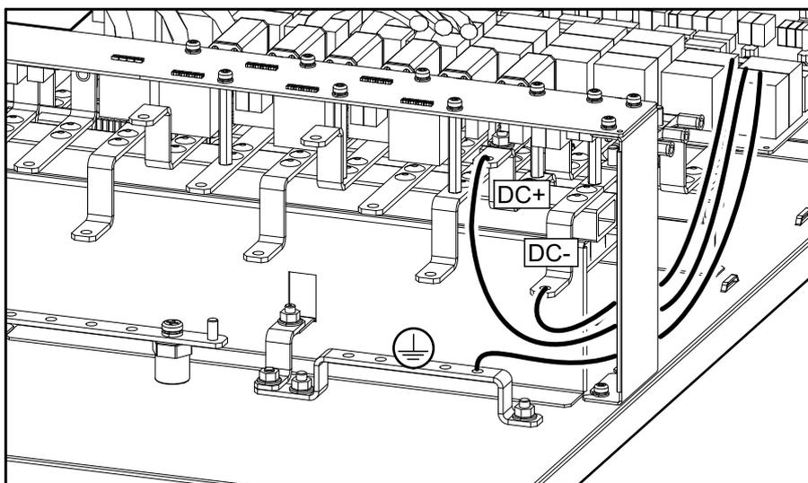
6. Far passare il cavo PE/conduttore messa a terra apparecchiature e i cavi CC nell'armadio delle batterie modulari 1 e collegare il cavo PE/conduttore messa a terra apparecchiature e i cavi CC nell'armadio delle batterie modulari 1.
