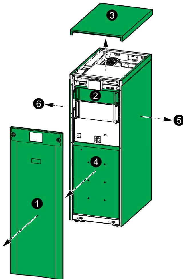
4. Rimuovere il coperchio delle batterie. Disconnettere i terminali delle batterie dalla parte anteriore dei moduli delle batterie.
