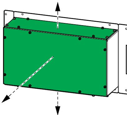
14. Trapanare/praticare fori per i cavi di alimentazione/condotti nella piastra isolante superiore o inferiore. Installare i condotti (non forniti), se presenti.
