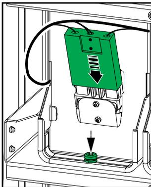
10. Reinstallare il coperchio delle batterie sull'UPS.
