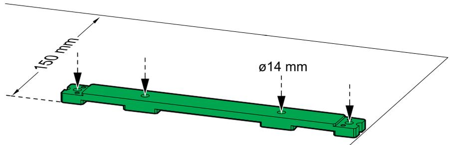
2. Installare la staffa di ancoraggio posteriore sull'UPS con i bulloni M8 in dotazione.
