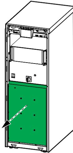
9. Disconnettere i terminali delle batterie dalla parte anteriore di tutti i moduli delle batterie.
