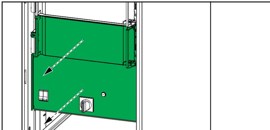
2. Installare un interruttore ausiliario aggiuntivo (fornito) nel sezionatore di manutenzione interno (IMB) su entrambi gli UPS.
