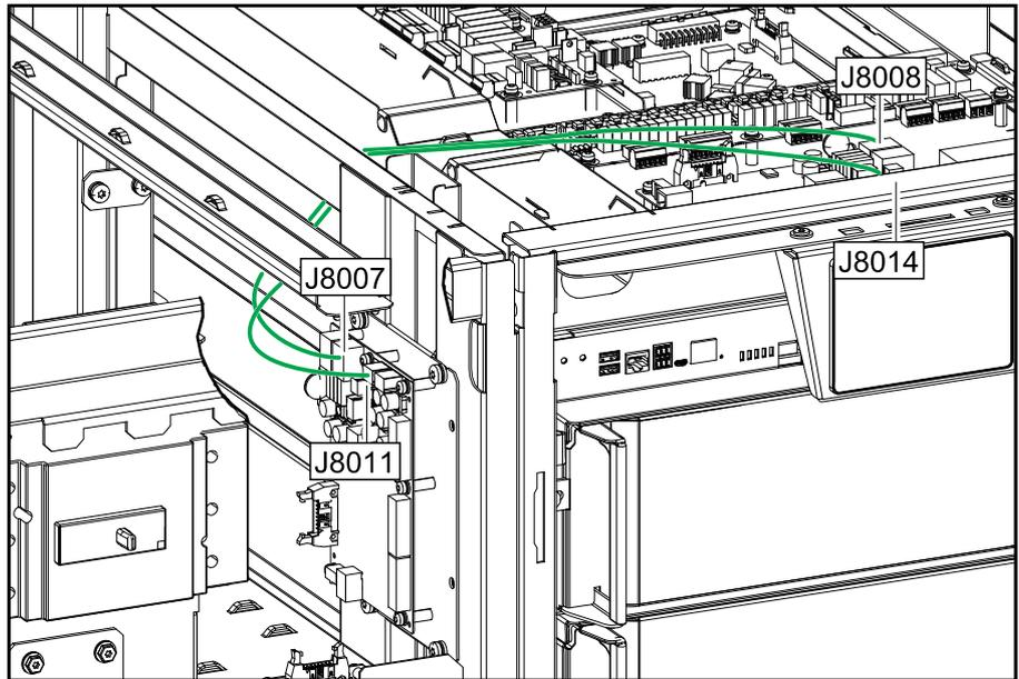
2. Collegare i cavi di segnale dall'armadio delle batterie modulari 1 all'UPS:
