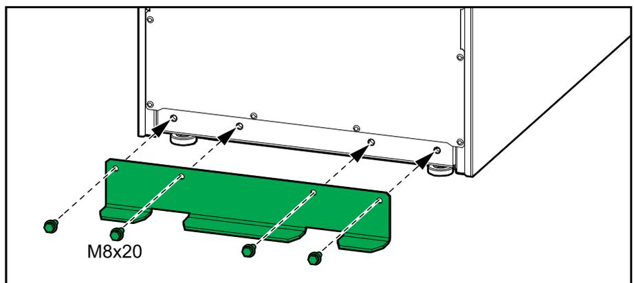
3. Installare la staffa di ancoraggio antisismico anteriore sull'UPS con i bulloni M8 in dotazione.
