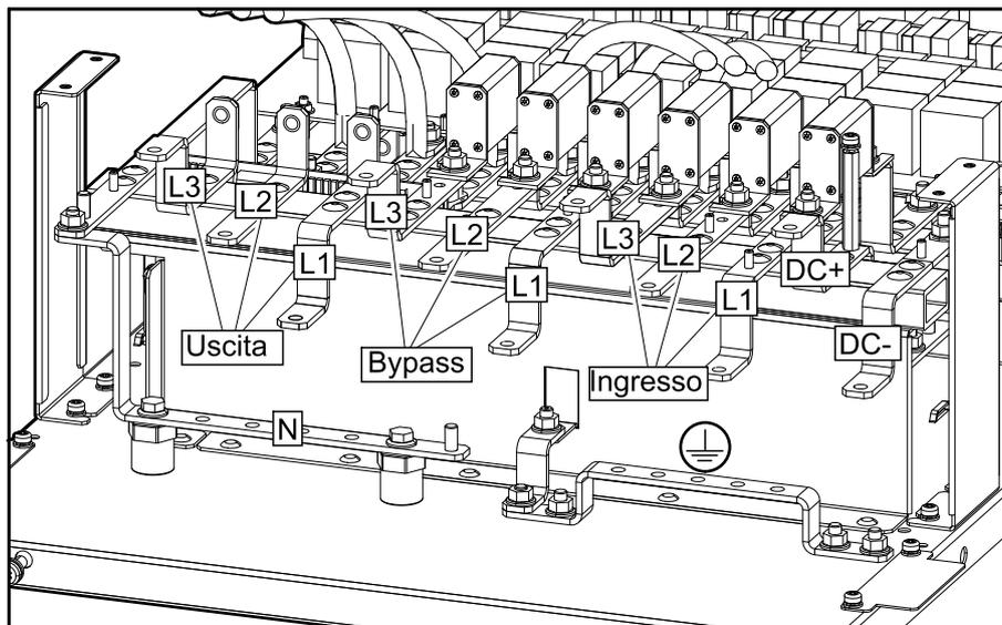
13. Scollegare e rimuovere tutti i cavi di alimentazione dall'UPS. Per maggiori dettagli, vedere Collegamento dei cavi di alimentazione nel sistema con singola rete di alimentazione, pagina 56 o Collegamento dei cavi di alimentazione nel sistema ad alimentazione doppia, pagina 58.
