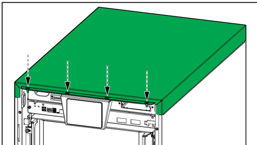
3. **Solo per l'ancoraggio antisismico:** Spingere l'UPS in posizione in modo che la staffa di ancoraggio posteriore si colleghi all'ancoraggio posteriore.
