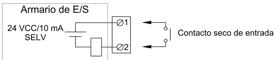
3. Un suministro externo resulta útil en los sistemas en paralelo en los que las entradas se conectan entre diferentes SAI. Es una forma de tener una referencia común y de evitar corrientes cruzadas.
