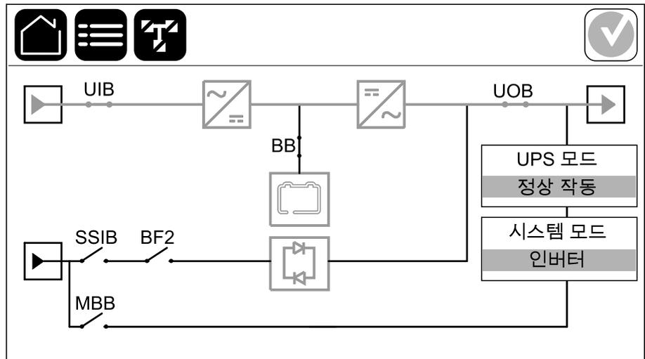
모형도의 녹색 전원선(그림에서는 회색)은 UPS 시스템의 전력 흐름을 보여줍니다. 활성 모듈(인버터, 정류기, 배터리, 스택 스위치 등)은 녹색으로 표시되고 비활성 모듈은 검은색으로 표시됩니다. 빨간색으로 표시된 모듈은 작동하지 않거나 알람 상태인 모듈입니다.
