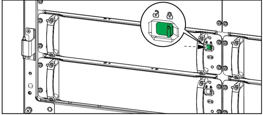
파워모듈은 자체 테스트를 수행하고 시스템에 따라 펌웨어를 자동으로 업그레이드 하면 온라인 상태가 됩니다. 자체 테스트 중 디스플레이에 표시되는 UPS 작동 모드가 배터리 작동으로 잠깐 변경된 후 이전 작동 모드로 돌아갑니다.
