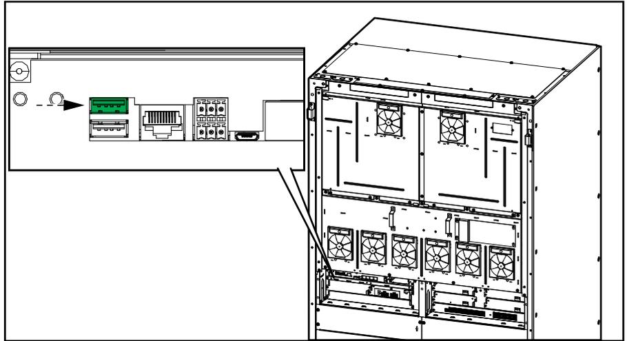
5. 복원을 눌러 USB 장치에서 저장된 UPS 설정을 실행합니다. 시스템 레벨 컨트롤러가 자동으로 재부팅될 때까지 대기합니다.
