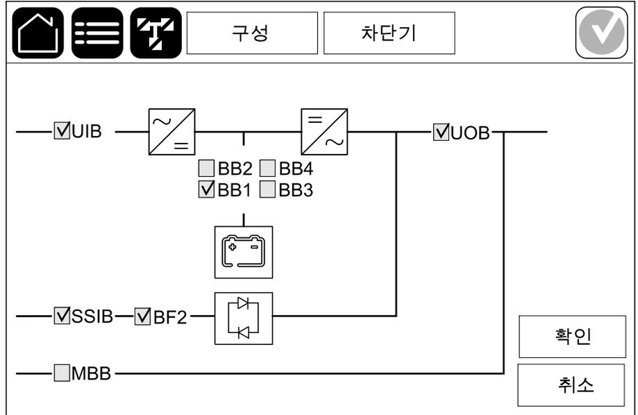
**주의:** 배터리 솔루션에서 UPS는 최대 4개의 배터리 차단 장치를 모니터링할 수 있습니다. 모니터링을 위해 더 많은 배터리 차단 장치가 연결되고 구성된 경우 모형도에는 하나의 배터리 차단 장치 BB만 표시됩니다. 하나 이상의 모니터링되는 배터리 차단 장치가 닫힘 위치에 있는 경우 모형도의 BB는 닫힘으로 표시됩니다. 모니터링되는 배터리 차단 장치가 모두 열림 위치에 있는 경우 모형도의 BB는 열림으로 표시됩니다.
