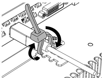
**注:** 您可以使用宽度 4.8 mm (0.19 in) 厚度 1.3 mm (0.05 in) 的市售扎带代替此扎带。
