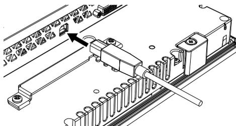
3. 如图所示转动扎带，将 USB 电缆固定到支架上，以便 USB 电缆从扎带环中穿过。
