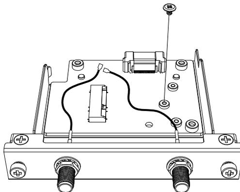
2. Setzen Sie die WiFi/Bluetooth-Karte gemäß Abbildung unten diagonal ein und drücken Sie dann von oben.
