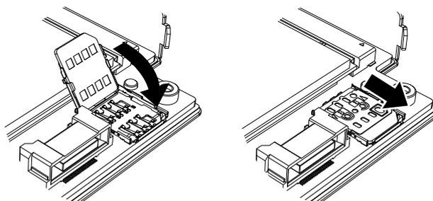
**HINWEIS:** Beim Entfernen, Einlegen oder Ersetzen der SIM-Karte muss 4G Cellular auf die Werkseinstellungen zurückgesetzt werden. Führen Sie unter 4G-Mobilfunkeinstellungen Schritt 1 aus.
