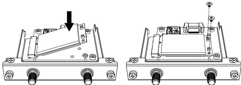
4. Stecken Sie den Stecker des Antennenkabels gemäß Abbildung unten in den Anschluss der 4G-Mini-PCle-Karte. Stecken Sie den Kabelstecker auf der linken Seite (bei Sicht von oben auf die Schnittstelle) in Anschluss 1 und den Kabelstecker auf der rechten Seite in Anschluss 2 ein.
