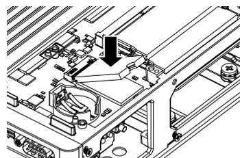
7. Befestigen Sie die M.2 SSD-Karte mit der in Schritt 5 entfernten Schraube.
