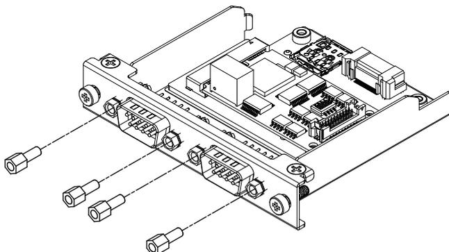
2. Trennen Sie den Schnittstellenstecker von der Kassette und das an die Platine angeschlossene Kabel.
