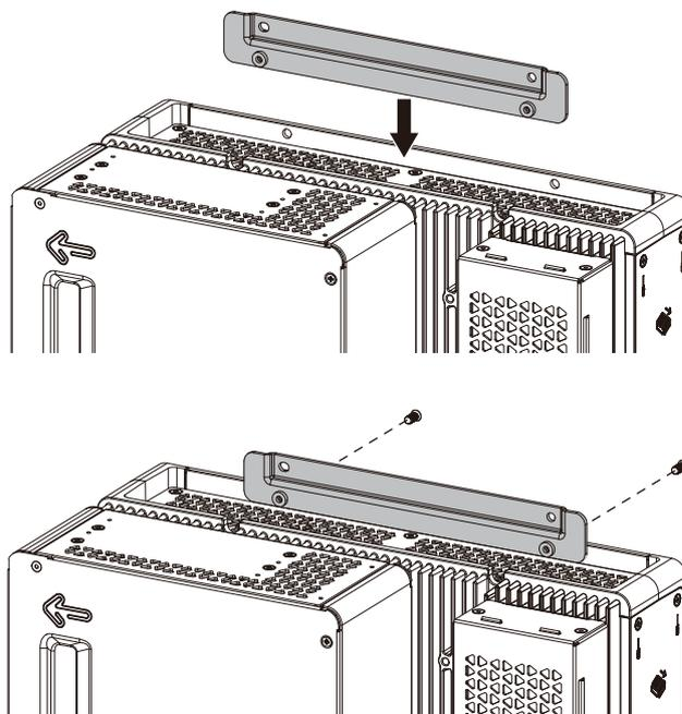
2. Installieren Sie das Produkt mit M4-Schrauben (4 Stück) an der Platte oder Wand.
