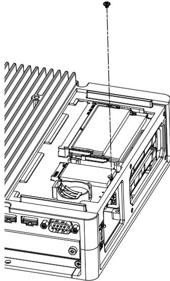
8. Ziehen Sie die Schutzfolie von der Unterseite des oberen Kühlkörperpads ab, und legen Sie sie auf die M.2 SSD-Karte. Ziehen Sie auch die Schutzfolie von der Oberseite des Kühlkörperkissens ab. Bei Verwendung der Advanced Box mit dem Lüftersatz ist dieser Schritt nicht erforderlich.
