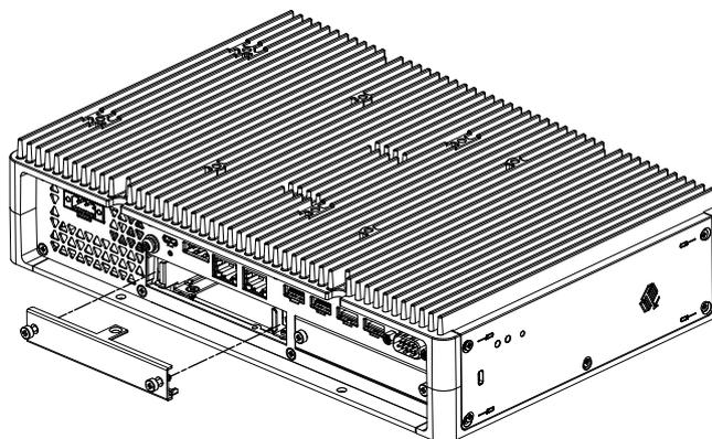
4. Setzen Sie die optionale Schnittstelle mit der mit „UP“ gekennzeichneten Seite nach oben in das Box-Modul ein, und ziehen Sie die Schrauben fest.
