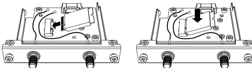
3. Befestigen Sie die Karte mit der in Schritt 1 entfernten Schraube.
