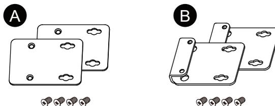
2. Entfernen Sie die am Produkt befestigten Schrauben (4 Stück), und befestigen Sie den Buchmontageadapter mit diesen Schrauben am Produkt. Bringen Sie bei Montage an der Oberseite des Produkts den Buchmontageadapter B so an, dass das hervorstehende Teil zum Produkt zeigt.
