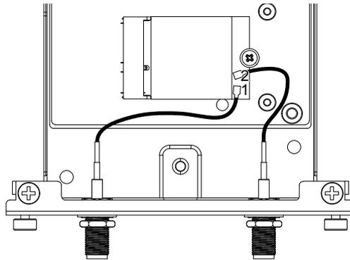
5. Bringen Sie diese Schnittstelle am Produkt an. Bringen Sie die Antenne erst an, nachdem Sie das Produkt auf der Montageplatte montiert haben.
