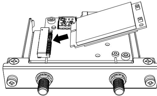
3. Schieben Sie die 4G Mini-PCle-Karte von oben hinein, und befestigen Sie sie mit den in Schritt 1 entfernten Schrauben.
