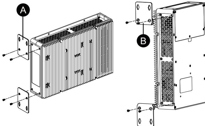
3. Installieren Sie das Produkt mit M4-Schrauben (4 Stück) an der Platte oder Wand.
