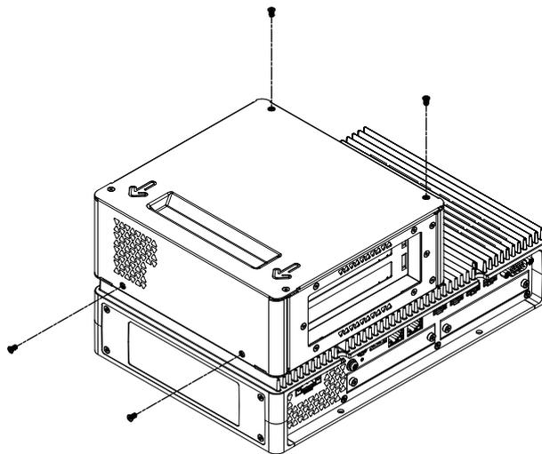
4. Schieben Sie die Abdeckung in Richtung des Pfeils oben auf die Abdeckung und nehmen Sie sie ab.
