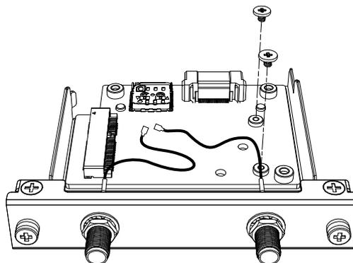
2. Schließen Sie die 4G Mini-PCle-Karte an den Steckplatz an.
