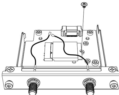
4. Stecken Sie den Stecker des Antennenkabels gemäß Abbildung unten in den Anschluss der Karte. Stecken Sie den Kabelstecker auf der linken Seite (bei Sicht von oben auf die Schnittstelle) in Anschluss 1 und den Kabelstecker auf der rechten Seite in Anschluss 2 ein.
