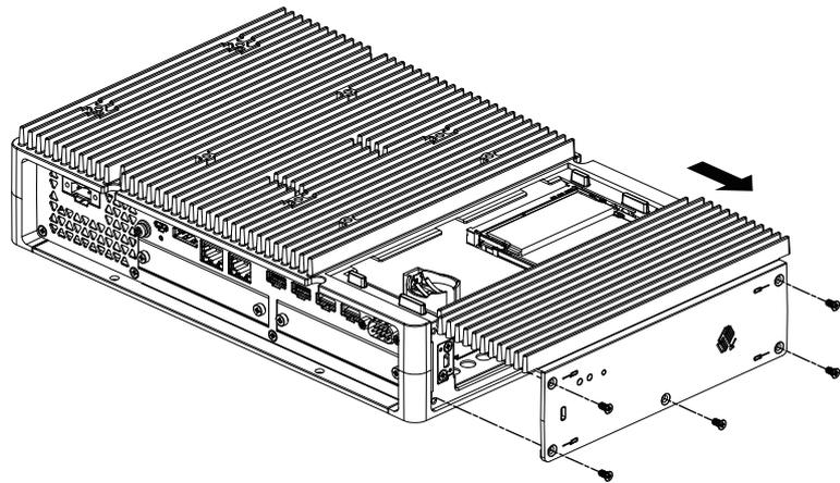
4. Führen Sie die HDD oder SSD in den Steckplatz ein.
