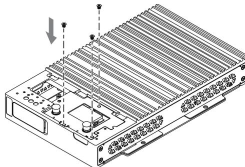
14. Posizionare la copertura opzionale dell'interfaccia sul Box Module.
