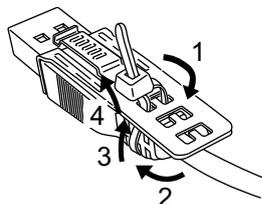
4. Mentre si preme l'impugnatura sulla molletta, inserire il cavo al Passo 3 completamente nell'interfaccia host USB. Assicurarsi che la linguetta della molletta sia assicurata sul cavo USB fissato a questo prodotto.
