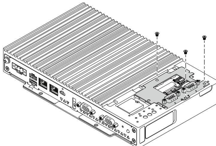
11. Posizionare la copertura opzionale dell'interfaccia sul Box Module.
