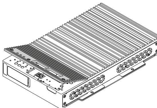
12. Fissare la copertura opzionale dell'interfaccia sul Box Module con le viti.
