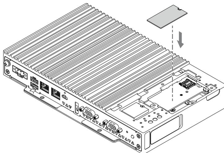
6. Inserire la vite M.2 nel foro della scheda M.2 RS-422/485.
