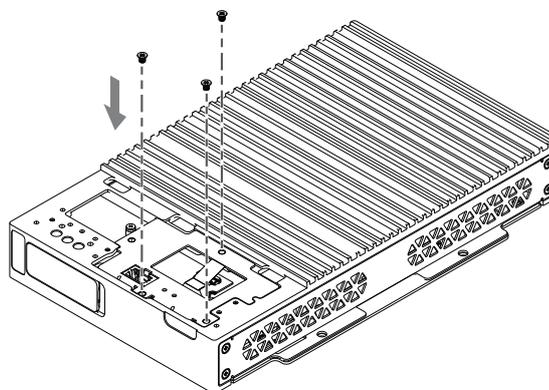
11. Posizionare la copertura opzionale dell'interfaccia sul Box Module.
