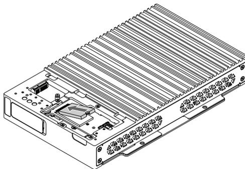
10. Fissare la scheda M.2 SSD con la vite M.2.
