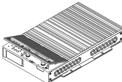
15. Fissare la copertura opzionale dell'interfaccia sul Box Module con le viti.
