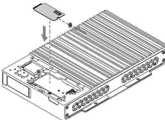
6. Inserire in diagonale la scheda Ethernet M.2 nel vano del prodotto.
