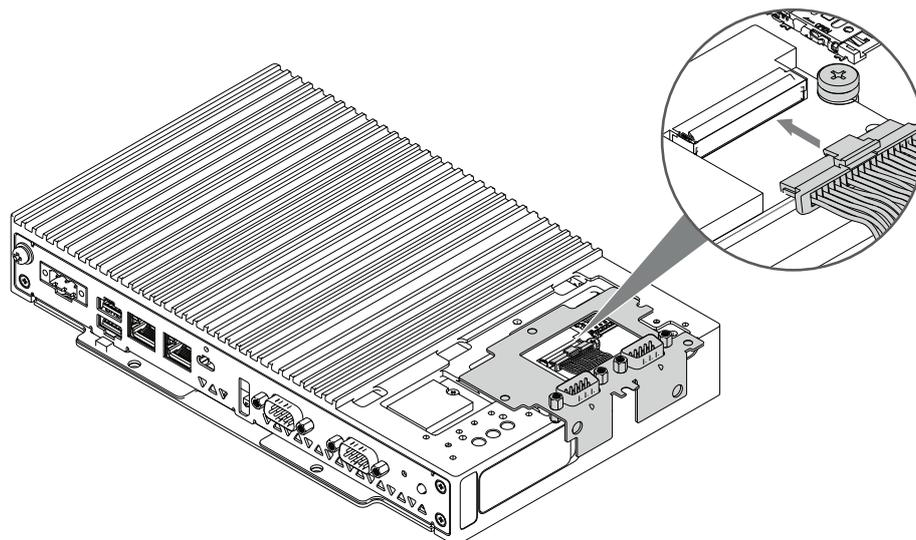
10. Fissare il supporto del modulo RS-422/485 sul prodotto e stringere con le viti M3.
