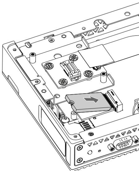
7. Fissare la scheda M.2 SSD con la vite rimossa al passo 4.
