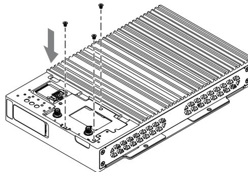
9. Posizionare la copertura opzionale dell'interfaccia sul Box Module.
