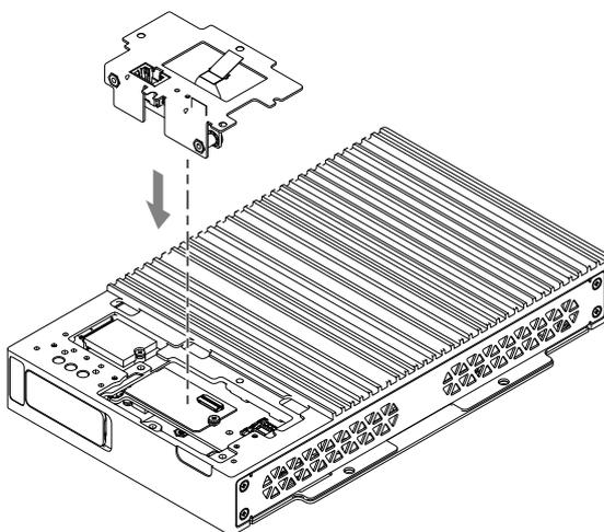
9. Collegare il cavo della porta del supporto del modulo Ethernet alla presa della scheda Ethernet M.2.
