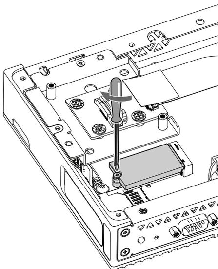
8. Posizionare la copertura posteriore del Box Module e stringere con le viti.
