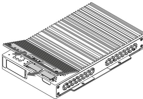
6. Rimuovere anche la pellicola protettiva dalla superficie superiore e dalla superficie inferiore della tampone dissipatrice di calore.
