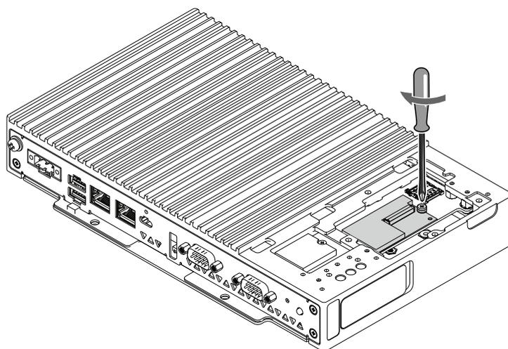
9. Collegare il cavo della porta del supporto del modulo RS-422/485 alla presa della scheda RS-422/485 M.2.
