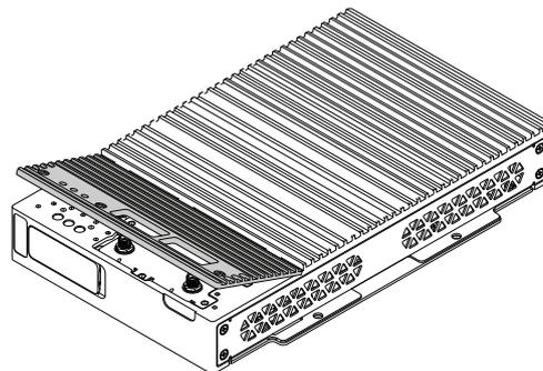
10. Fissare la copertura opzionale dell'interfaccia sul Box Module con le viti.
