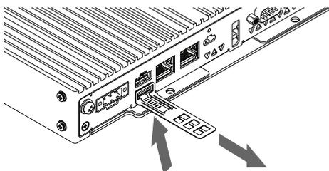
**NOTA:** Per gli USB di Tipo C, rimuovere il cavo USB spingendo la sezione dell'impugnatura del morsetto.
