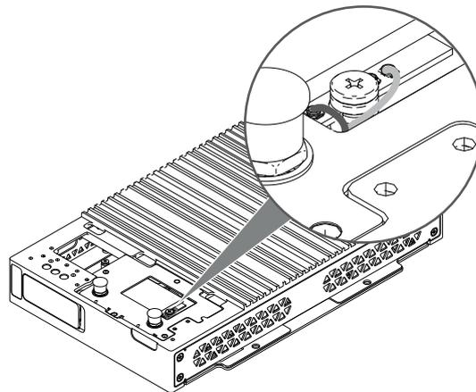
13. Fissare il supporto del modulo 4G sul prodotto e serrare con le viti M3.
