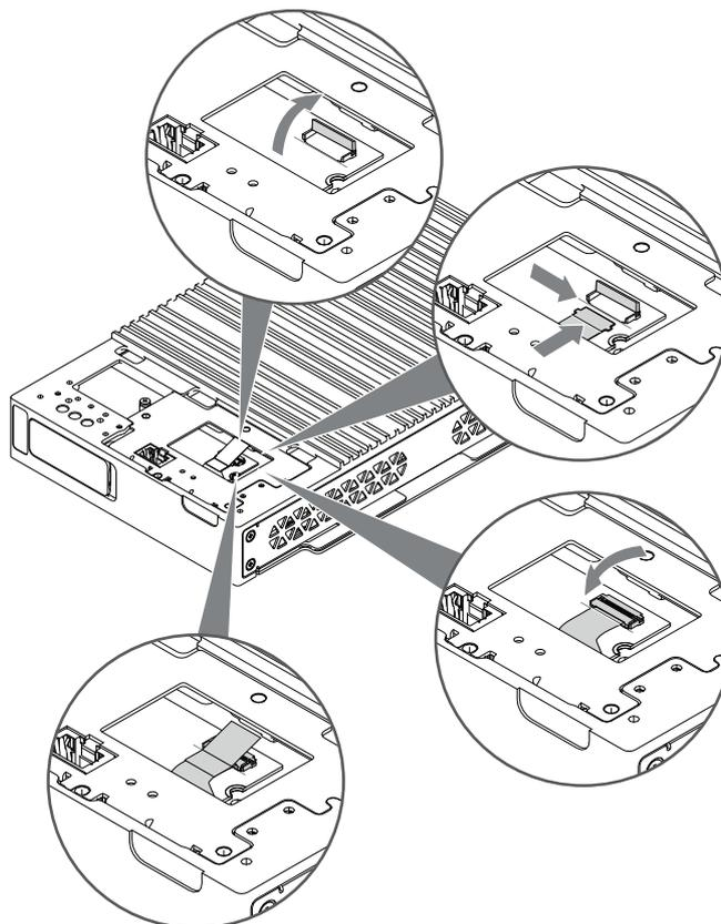
10. Fissare il supporto del modulo Ethernet al prodotto con viti M3.
