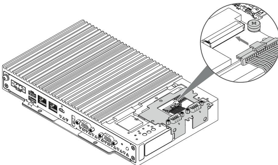
10. Fissare il supporto del modulo RS-232C sul prodotto e serrare con le viti M3.
