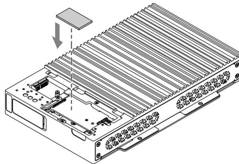
6. Inserire la vite M.2 nel foro della scheda M.2 4G.
