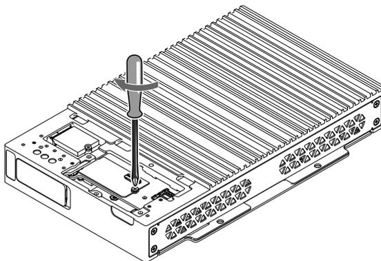
8. Posizionare il supporto del modulo Ethernet sul prodotto.
