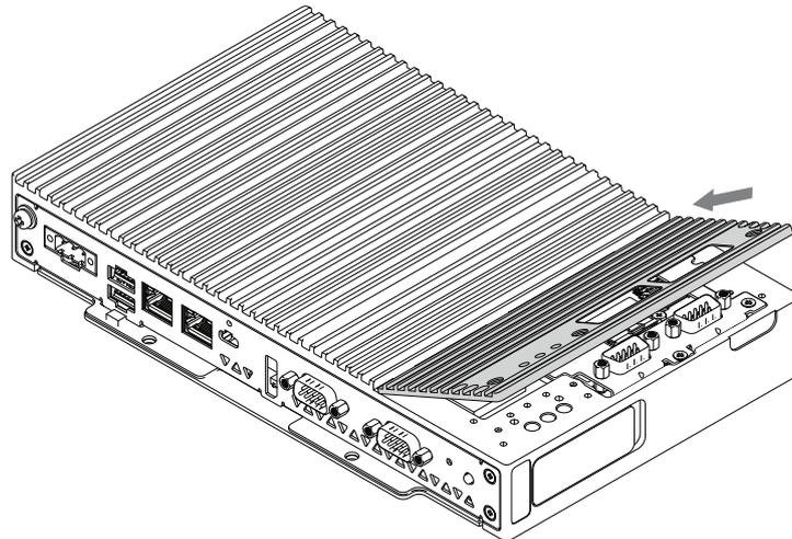
12. Fissare la copertura opzionale dell'interfaccia sul Box Module con le viti.
