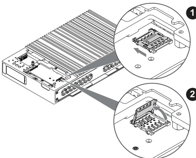
10. Inserire la scheda SIM nel suo vano e chiudere facendo scorrere il coperchio in direzione della freccia per bloccarlo.
