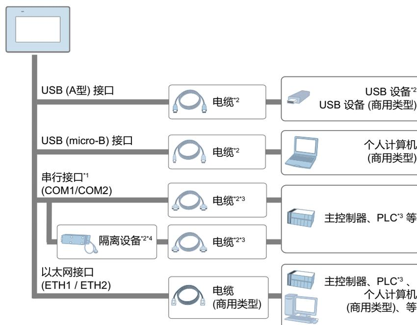
\*1 要将它用作隔离端口，需要隔离设备。要使用 RS-232C 隔离设备，请将串口的 #9 引脚设置为 VCC。
