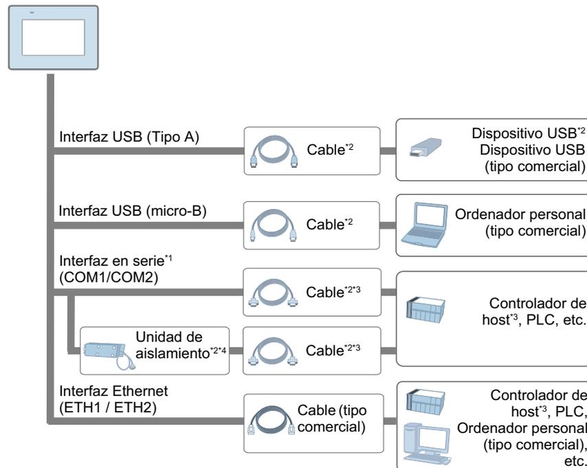
\*1 Con el fin de utilizar este puerto como un puerto aislado, se requiere una Unidad de Aislamiento. Para usar una unidad de aislamiento RS-232C, establezca el pin #9 del puerto COM en VCC.
