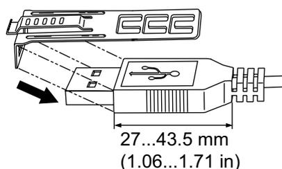
2. 请将夹子与 USB 电缆接头的外壳对齐。调整夹子开孔的位置。为了确保稳定性，请选择最靠近接头外壳基座的开孔。
