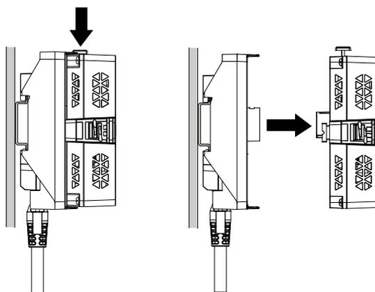
2. 向下推背后模块安装适配器，然后将适配器底部从DIN导轨上取下。
