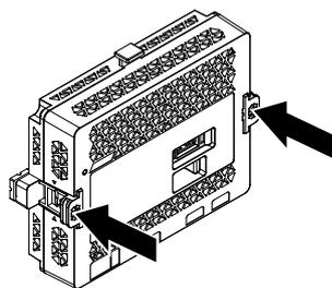
**注:** 要将缓冲器恢复到原来的位置，请使用螺丝刀或其他工具作为支杆将缓冲器向上推。
