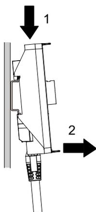
3. 按住分离电缆顶部的按钮，然后将分离电缆径直拉出。
