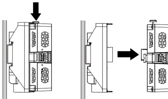
2. 向下推背后模块安装适配器，然后将适配器底部从 DIN 导轨上取下。
