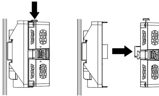
2. Drücken Sie den Adapter für die Montage des hinteren Moduls nach unten, und haken Sie den unteren Teil des Adapters von der DIN-Schiene aus.
