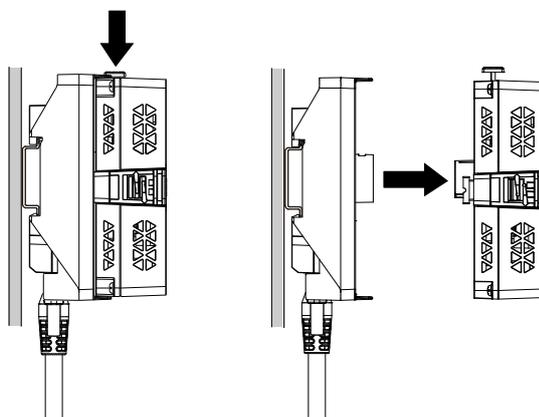
2. Drücken Sie den Adapter für die Montage des hinteren Moduls nach unten, und haken Sie den unteren Teil des Adapters von der DIN-Schiene aus.
