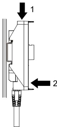
4. Setzen Sie das hintere Modul ein, und drücken Sie es gerade hinein, bis es einrastet.
