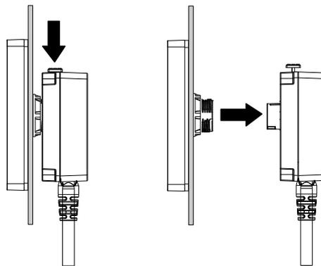
4. Entfernen Sie die Mutter und das Anzeigemodul von der Platte.
