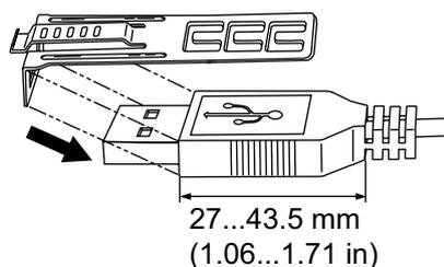
2. Justieren Sie die Klemme mit dem USB-Kabelsteckergehäuse. Justieren Sie die Position der Löcher, wo die Klemme befestigt ist. Wählen Sie zur Stabilität die Klemmen-Loch-Position, die dem Steg des Steckergehäuses am nächsten ist.
