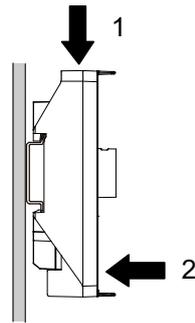
3. Setzen Sie das hintere Modul ein, und drücken Sie es gerade hinein, bis es einrastet.
