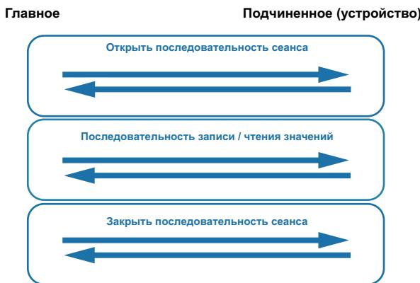
В течение активного сеанса могут выполняться множественные операции чтения/записи Modbus/98, но при этом после определенной последовательности требуется обязательное закрытие сеанса.
