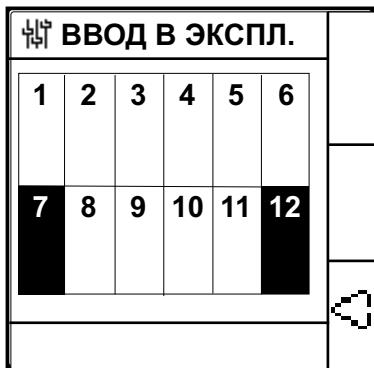
**Примечание:** Если оба смоделированных пробоя изоляции являются пробоями с нулевым сопротивлением, то устройство отображает пробой изоляции только на одном канале 7 или 12.
