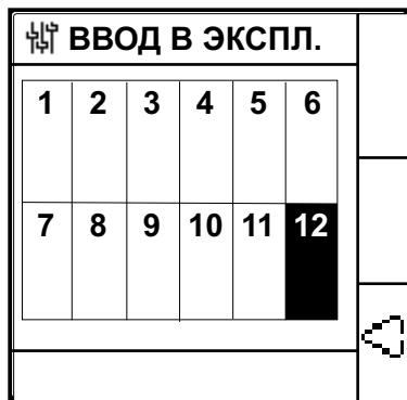
4. Устранитe смоделированный пробой изоляции на канале 12.
