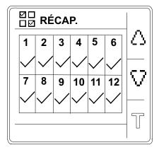
Exemple avec 12 canaux mis en service et 3 canaux (canaux numéro 2, 6 et 10) affichant une alarme d'isolement :
