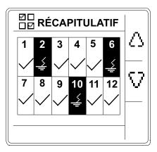
Exemple avec 12 canaux mis en service et 3 canaux (canaux numéro 2, 6 et 10) affichant une alarme d'isolement acquittée :
