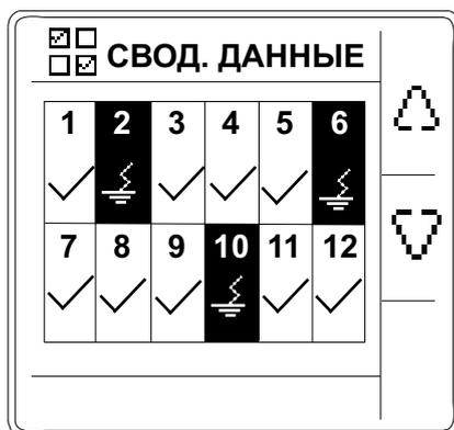
Пример, когда 12 каналов введены в эксплуатацию, и 3 канала (номера каналов: 2, 6 и 10) имеют подтвержденный сигнал о пробое изоляции:
