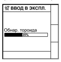
• Если тороид обнаружен, отображается экран **Ввод в эксплуатацию**. Пример, когда подключены и обнаружены все 12 тороидов:
