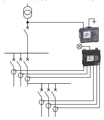
Пример применения: Поиск пробоя изоляции при помощи прибора контроля изоляции IMD, когда устройство и IMD подключены к внешней сети
