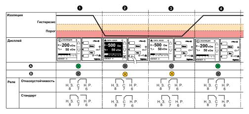
Изоляция электросети в норме, сигналы на каналах отсутствуют.
