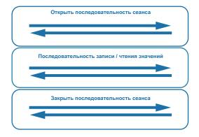
В течение активного сеанса могут выполняться множественные операции чтения/записи Modbus/98, но при этом после определенной последовательности требуется обязательное закрытие сеанса.
