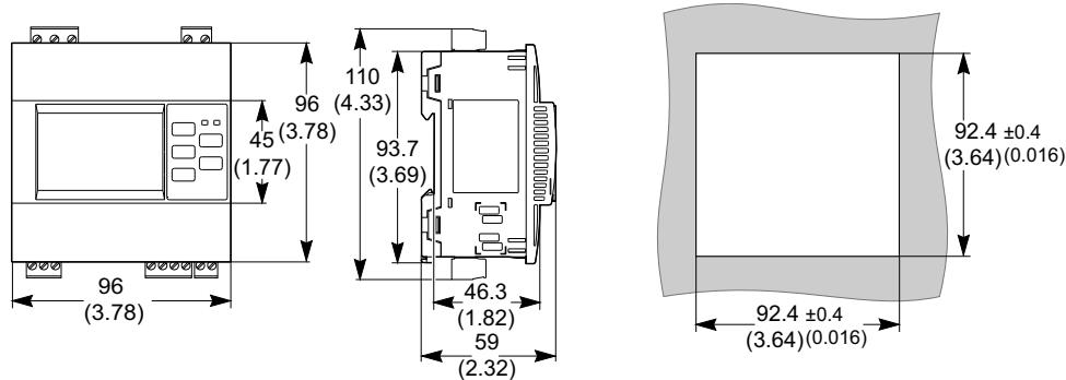
Achten Sie bei der flächenbündigen Montage auf die korrekten Abstände zwischen den Geräten entsprechend der folgenden Abbildung:
