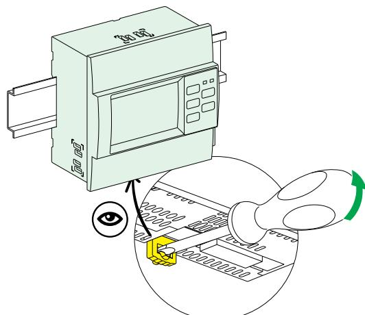
3. Heben Sie das Gerät an, um es aus der DIN-Schiene zu entfernen.
