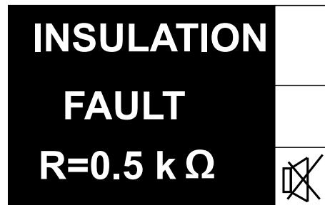
Der Bildschirm blinkt jedes Mal, wenn ein Isolationsalarm erkannt wird.
