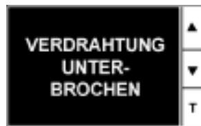
Der Parameter zur Erkennung einer getrennten Einspeisung (Parameter **Einspeisung trennen** ist auf **EIN** eingestellt).
