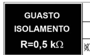
La schermata lampeggia quando viene rilevato un allarme isolamento.
