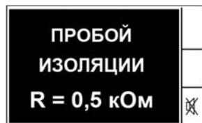
Экран мигает при обнаружении пробоя изоляции.
