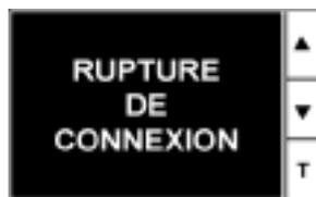
Par défaut, le paramètre de détection d'injection déconnectée est activé (paramètre **Déconnex. Inj.** est réglé sur **ON**).
