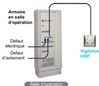
Le schéma suivant représente le principe de connexion du HRP :
