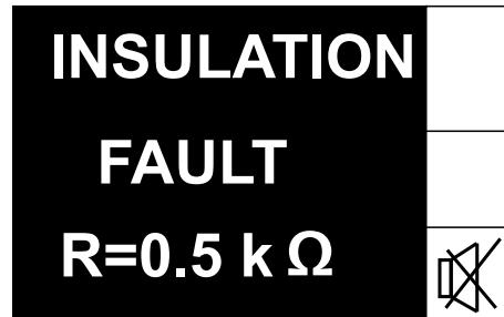
A tela pisca sempre que um alarme de isolamento ou transformador é detectado.
