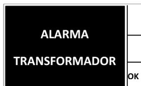
Pulse el botón **OK** para salir de la pantalla. Posteriormente, se mostrará la pantalla de alarma del transformador afectado por el fallo.
