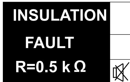
La pantalla parpadea siempre que se detecta una alarma de aislamiento o transformador.
