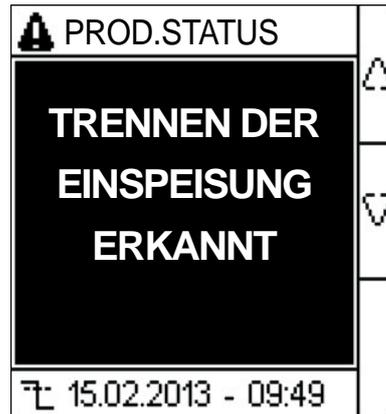
Der Parameter zur Erkennung einer getrennten Einspeisung (Parameter **Einspeisung trennen** ist auf **EIN** eingestellt).
