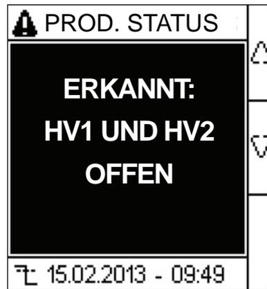
Wenn die Klemmen HV1 und HV2 nicht kurzgeschlossen sind und der Parameter **Adapter (V)** auf **Keine** eingestellt ist, zeigt das Gerät den Widerstand des nicht geerdeten Netzes an.
