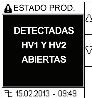
Cuando los terminales HV1 y HV2 no están cortocircuitados y el parámetro **Adapt. V** está establecido en **Ninguno**, el dispositivo muestra la resistencia del sistema sin conexión a tierra.
