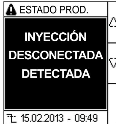
De manera predeterminada, el parámetro de detección de inyección desconectada se activa (parámetro **Inyecc. desc.** establecido en **ENCENDIDO**).
