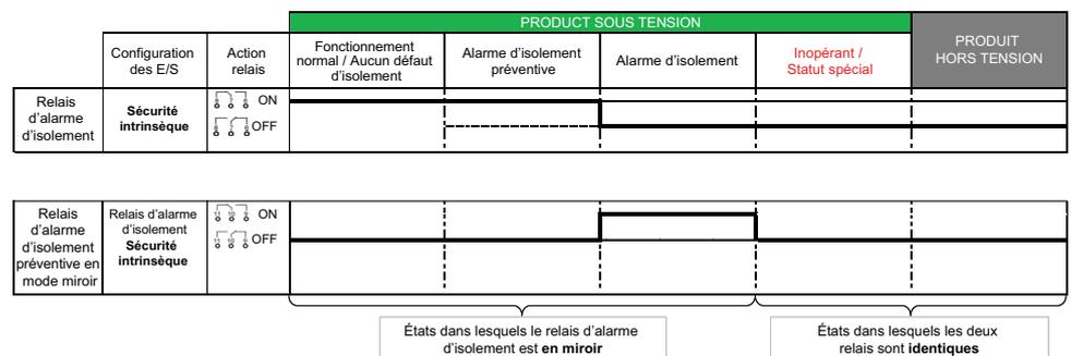
Vous pouvez ainsi facilement séparer un signal de défaut d'isolement d'un signal de produit inopérant avec une série de câblages simples (ou par la connexion à un automate programmable).
