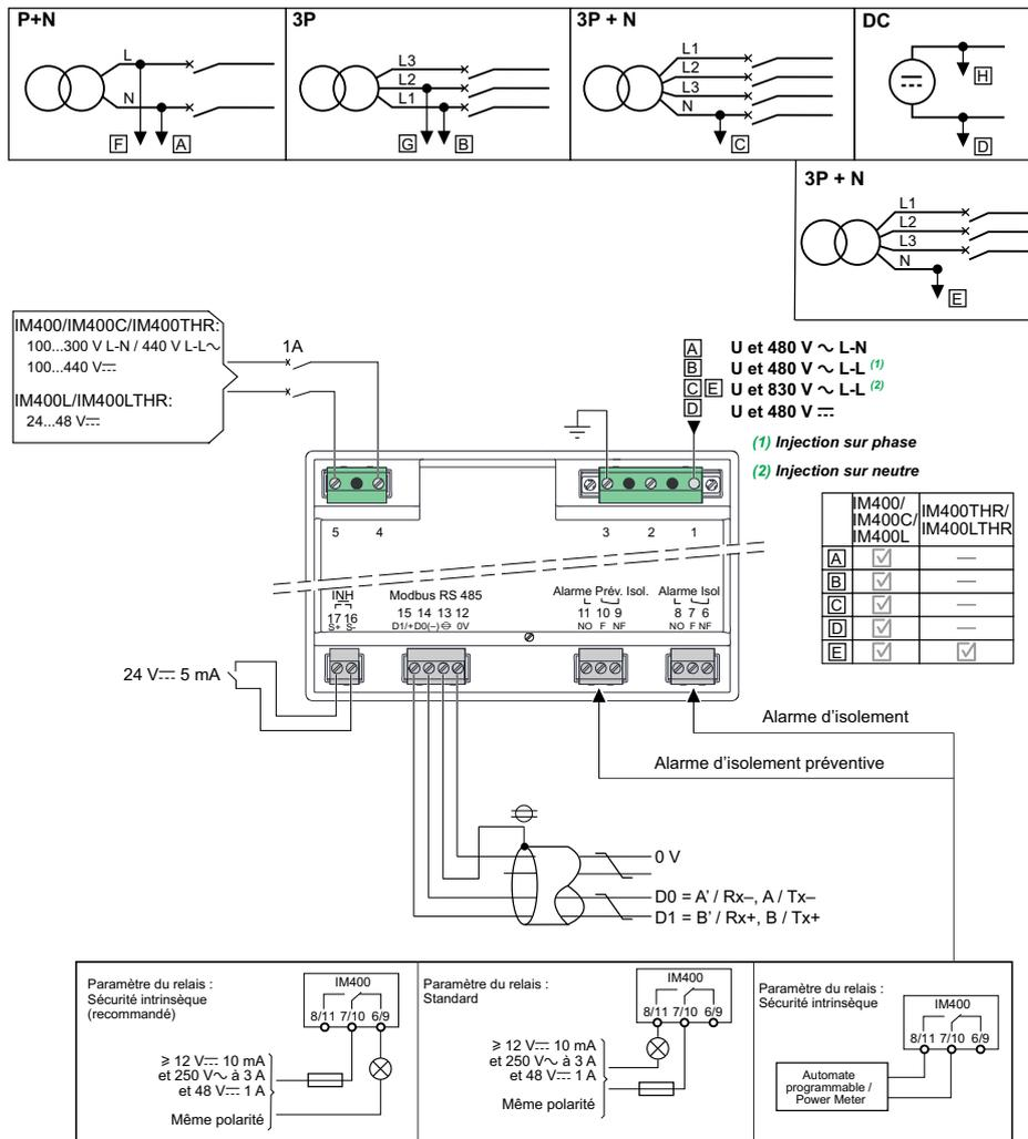
**NOTE:** Les disjoncteurs (référence MGN61334 ou équivalent) peuvent être utilisés pour remplacer les fusibles de la liste.
