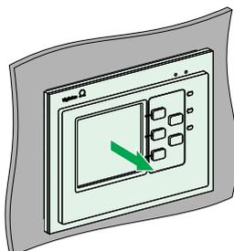
5. Réinsérez les borniers en veillant à respecter les positions sur l'appareil (voir Vue d'ensemble du matériel, page 12).
