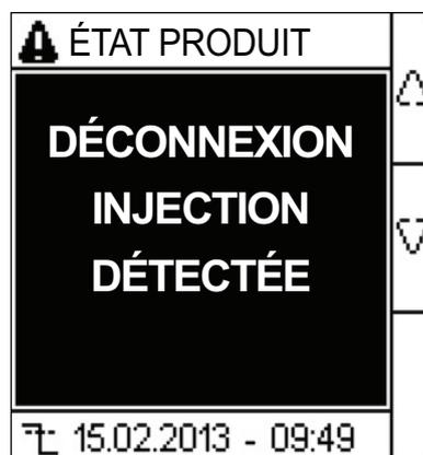
Si le paramètre **Déconnex. Inj.** est réglé sur **OFF**, l'appareil affiche **R > 10 MΩ**.
