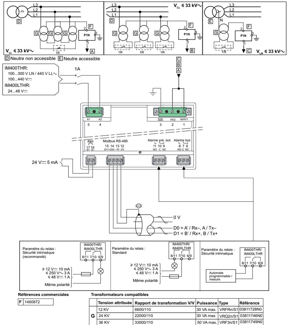
Les transformateurs de tension et l'adaptateur de terre P1N servent à raccorder IM400THRaux réseaux de tension nominale jusqu'à 33 kVCA. Les transformateurs de tension doivent être sélectionnés de manière appropriée en fonction de la tension du système. Voir le Schneider Electric catalogue des transformateurs de moyenne tension.
