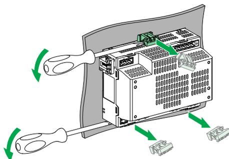
3. Desserrez les 2 clips à ressort sur le côté de l'appareil.
