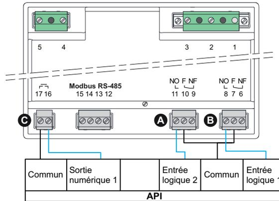
Pour que l'automate programmable puisse reconnaître l'état de tous les produits, la configuration suivante doit être implémentée :
