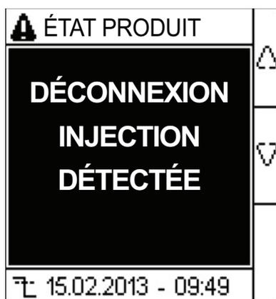
Par défaut, le paramètre de détection d'injection déconnectée est activé (paramètre **Déconnex. Inj.** est réglé sur **ON**).
