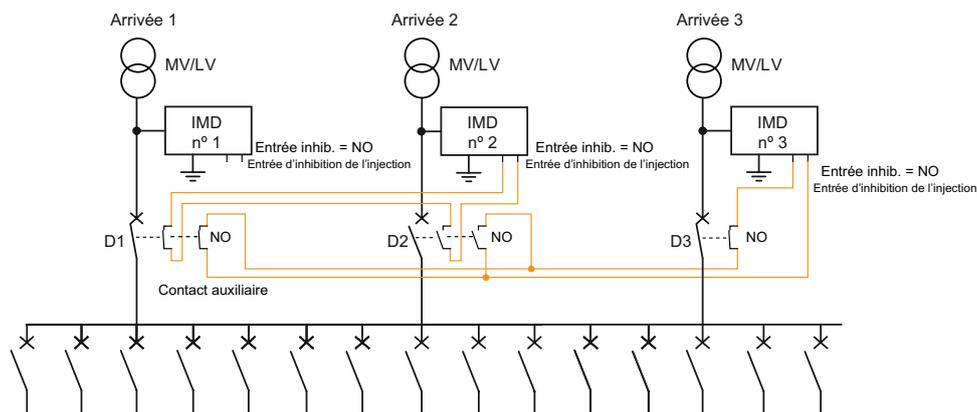
Utilisation de disjoncteurs avec contacts auxiliaires normalement fermés (NF) :
