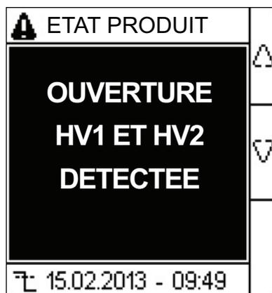
Lorsque les bornes HV1 et HV2 ne sont pas court-circuitées et que le paramètre **Adapt. V.** est réglé sur **Sans**, l'appareil affiche la résistance du système non mis à la terre.
