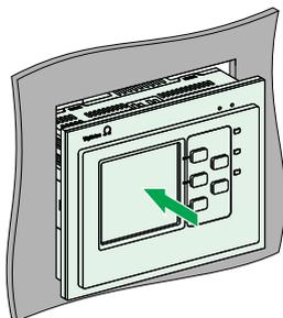
2. En fonction de l'épaisseur de la plaque de montage, clipsez les clips à ressort dans les logements de montage de l'appareil comme suit :
