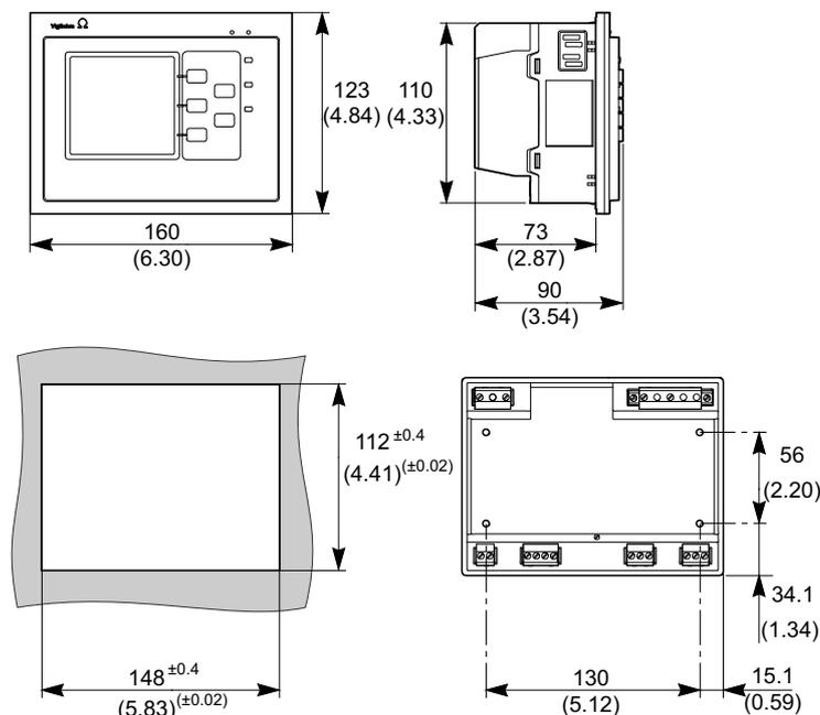
Respectez les distances appropriées entre appareils pour un montage encastré conformément à la figure suivante :
