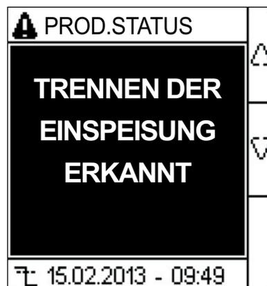
Wenn der Parameter **Einsp. trennen** auf **AUS** eingestellt ist, zeigt das Gerät **R > 10 MΩ** an.
