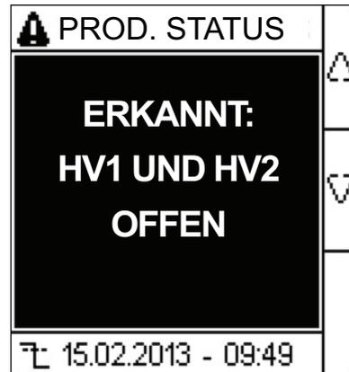
Wenn die Klemmen HV1 und HV2 nicht kurzgeschlossen sind und der Parameter **Adapter (V)** auf **Keine** eingestellt ist, zeigt das Gerät den Widerstand des nicht geerdeten Netzes an.
